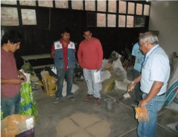
Fotografía N° 19: peso unitario suelto Agregado fino
