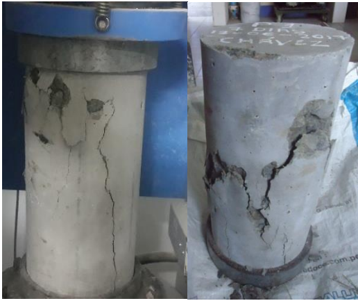
PATRON 7 DIAS Fractura tipo I.
