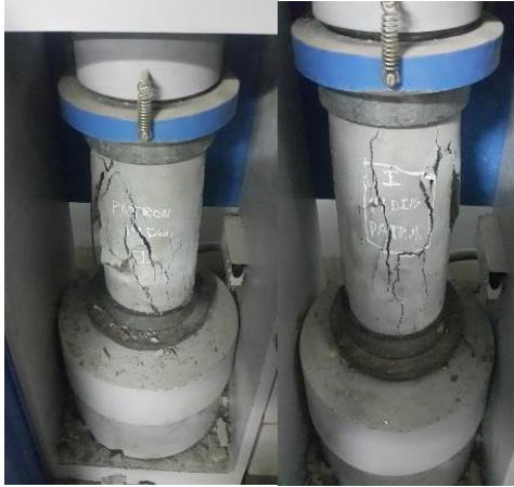
PATRON 14 DIAS Fractura tipo III
