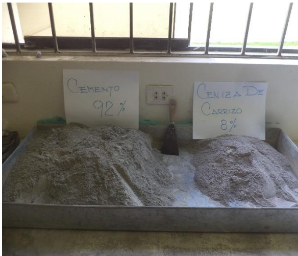
Fotografía N° 38: sustitución del cemento por la ceniza al 8%
