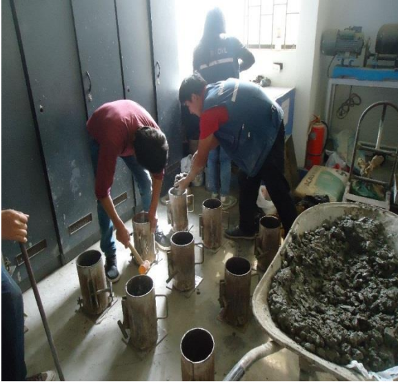
Fotografía N° 32: llenando las probetas y dando golpes con el martillo de goma
