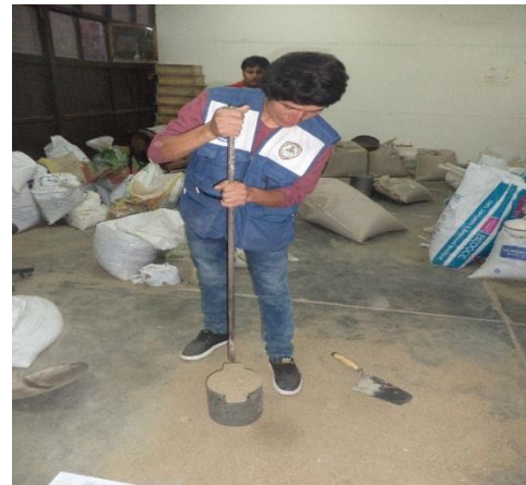
Fotografía N° 20: peso unitario compactado Agregado Fino
