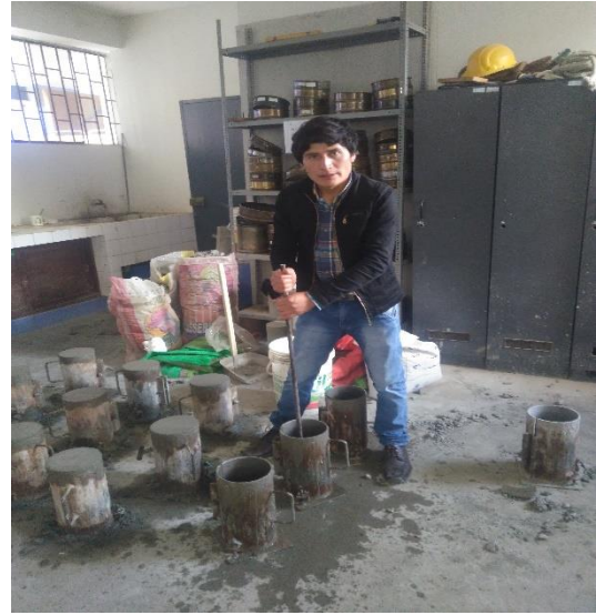
Fotografía N° 33: con la varilla en cada una de las tres capas se da 25 golpes cada capa
