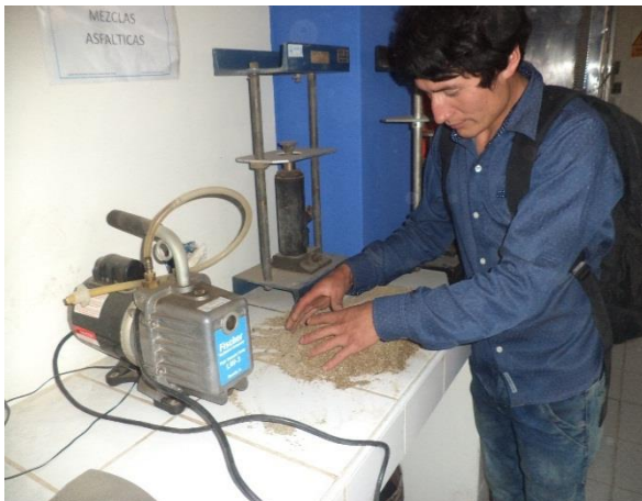
Fotografía N° 25: Gravedad específica y absorción de agregado fino según la norma ACTM C-16
