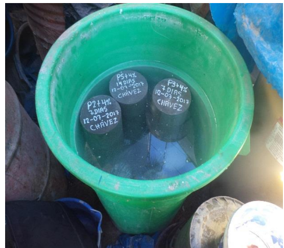
Fotografía N° 43: proceso de curado de las probetas 4% y 8%.
