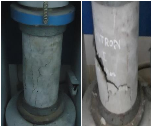
PATRON 28 DIAS Fractura tipo IV.
