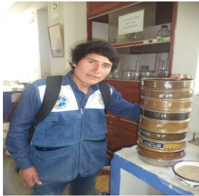
Fotografía N° 27 granulometría del agregado fino.
