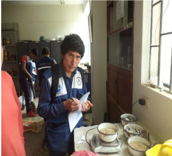
Fotografía N° 23: Contenido de humedad de agregado fino según la norma ASTD M 2216
