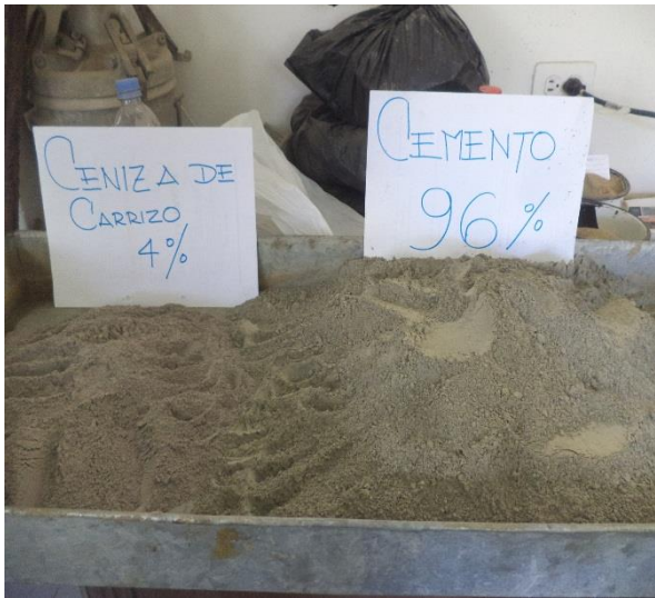
Fotografía N° 36: sustitución del cemento por la ceniza al 4%
