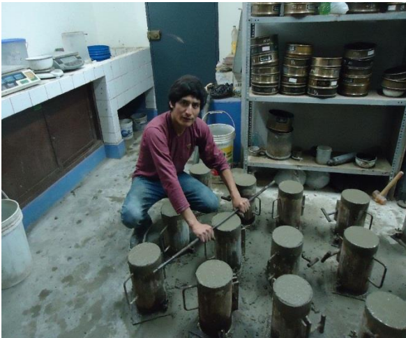
Fotografía N° 34: enrazado de las probetas Para luego pulirlo.
