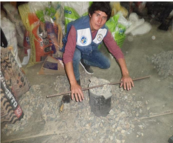
Fotografía N° 21: peso unitario suelto Agregado grueso
