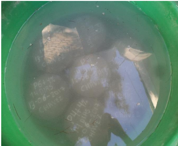
Fotografía N° 42: proceso de curado de las probetas patrón.
