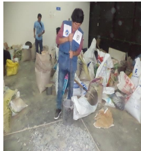
Fotografía N° 22: peso unitario compactado Agregado grueso
