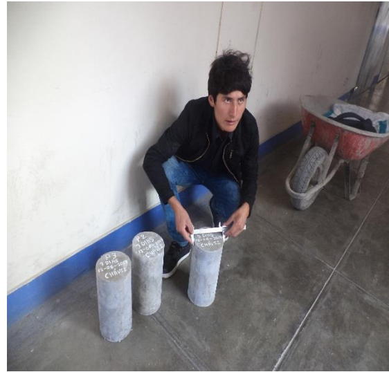
Fotografía N° 41: midiendo el diámetro de las probetas
