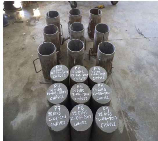
Fotografía N° 35: desencofrado de las probetas patrón.
