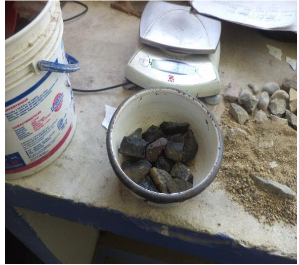
Fotografía N° 24: Contenido de humedad de agregado grueso según la norma AST M 2216
