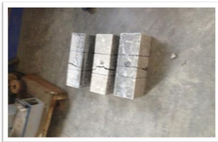
FOTO N° 18: VIGAS PATRÓN ENSAYADAS A LA EDAD DE 7 DÍAS
