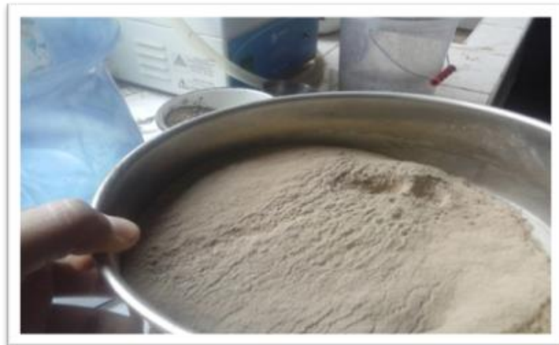
FOTO N° 05: OBTENCION DE LA CENIZA DE LODO DE PAPEL POR LA MALLA N°200
