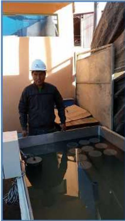
*Foto 25 Curado de muestras de concreto*
