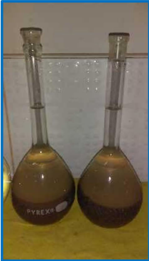
*Foto 6 Pe y absorción de agregado fino*
