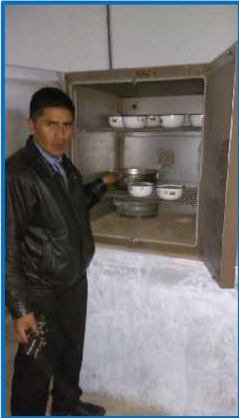
*Foto 1 Secado en horno para contenido de humedad.*
