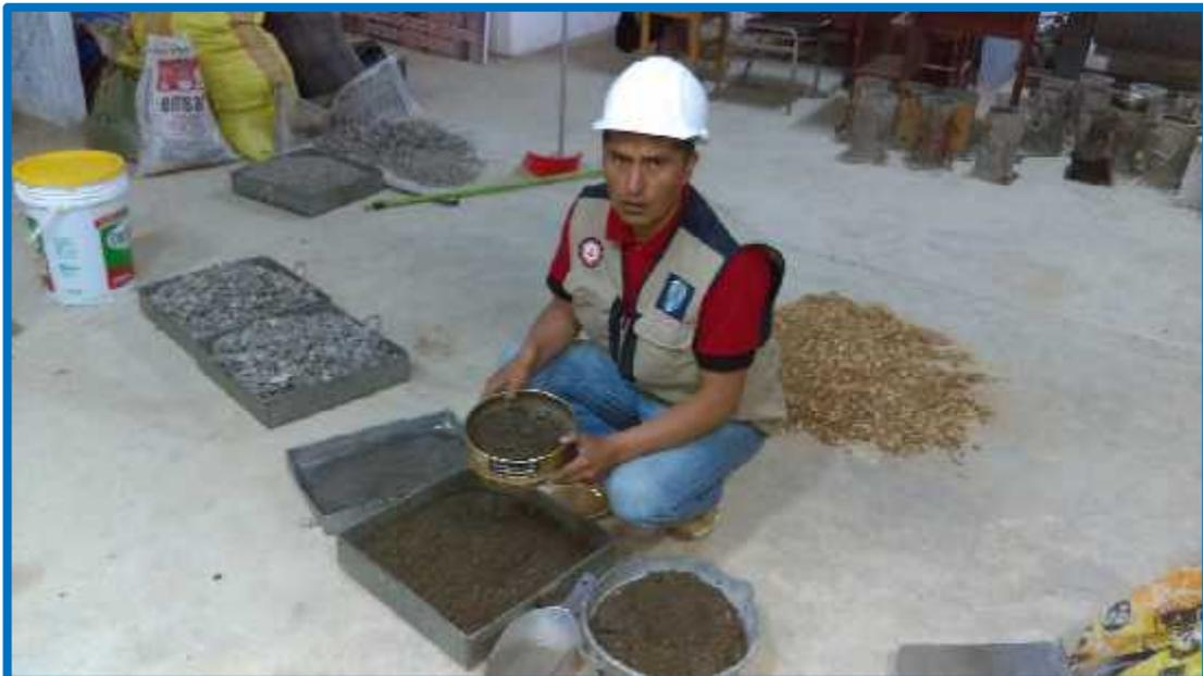
*Foto 3 Tamizado de agregado fino*
