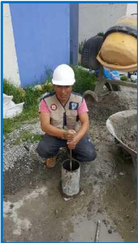
Foto 23 Vaciado de mezcla a probeta
