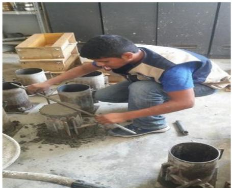
FOTO N°29: Enrazado Probeta Patrón
