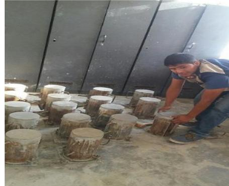
FOTO N°30: Desencofrado Probeta Patrón
