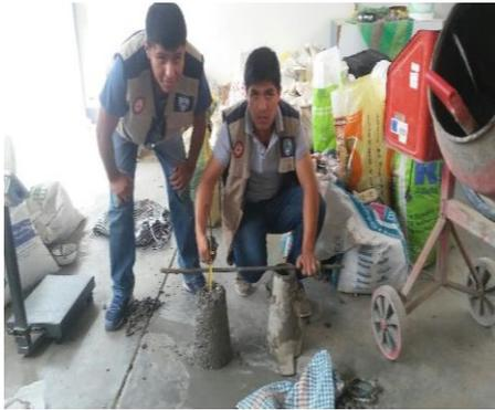
FOTO N°27: Cono de abrams Probeta Patrón
