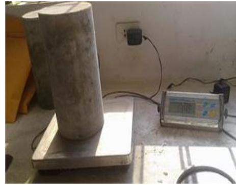
FOTO N° 38: Pesado de Probetas
