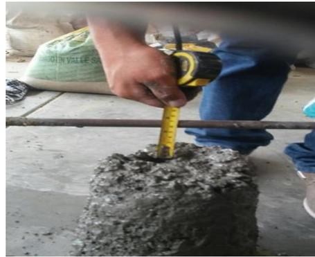
FOTO N°28: slump Probeta Patrón
