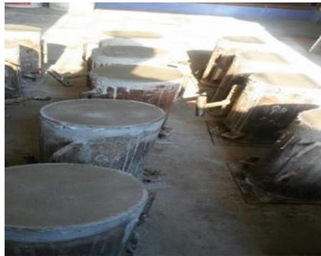
FOTO N°36: Probetas moldeadas
