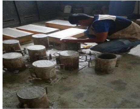
FOTO N°34: Enrazado de probetas
