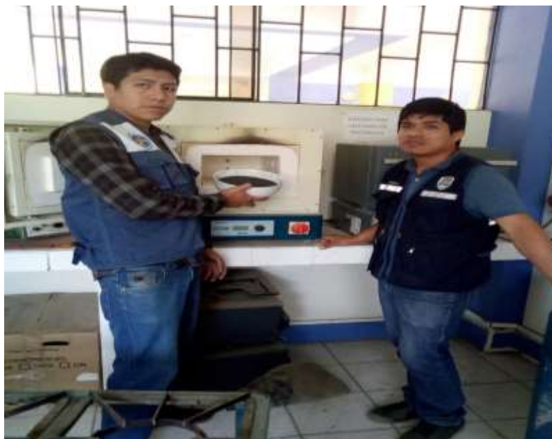
Foto 4: Calcinación a Temperatura Controlada (400 °C) de las Cenizas de Hojas Maíz por 1 Hora. Fuente: El autor
