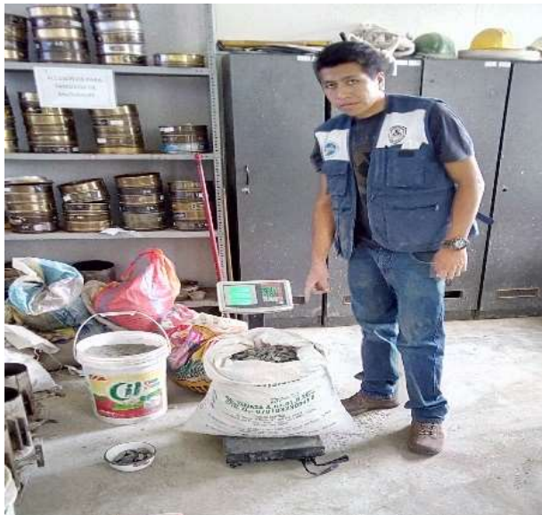
Foto 10: pesado de los materiales para el concreto Fuente: El autor
