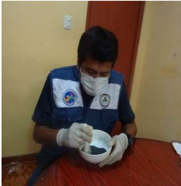
Foto 5: molienda manual de las cenizas de hojas de maíz activadas. Fuente: El autor
