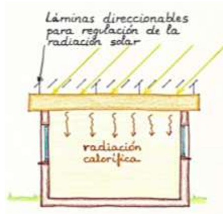
Figura 35 . Sistema captador indirecto - cubierta de inercia térmica.
