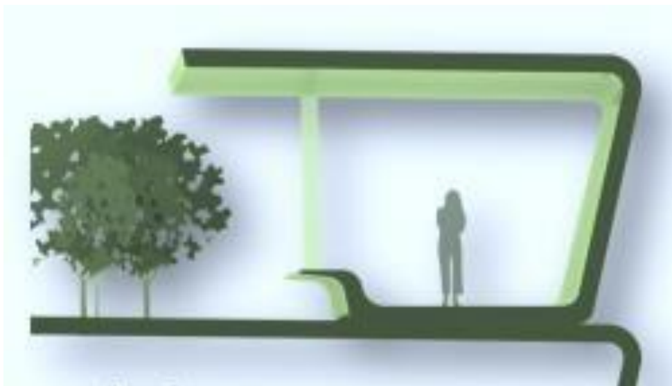
Figura 47. Los voladizos reducen la incidencia solar y dan calidad y confort al ambiente
