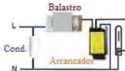
Figura 13. Conexión Balastro electromagnético Fuente: adaptado de RAT (2018a)
