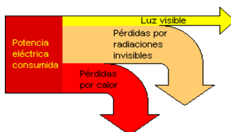
Figura 12. Diagrama de eficiencia luminosa
