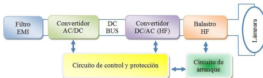
Figura 15. Estructura típica de un balastro electrónico Fuente: Adaptado de Rashid (2011)
