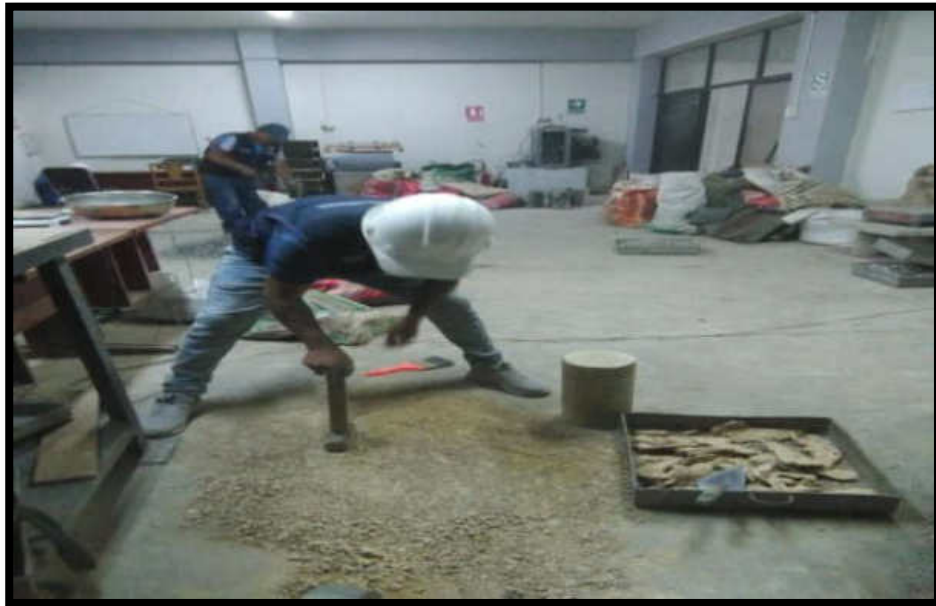
Foto N° 9: Trituración de la arcilla calcinada
