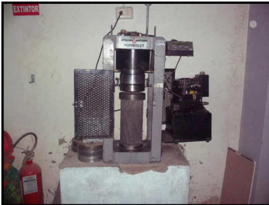
Foto N° 16: rotura con la prensa de carga axial
