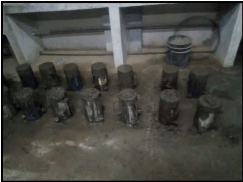
Foto N° 12: Final de colocado de concreto en las probetas
