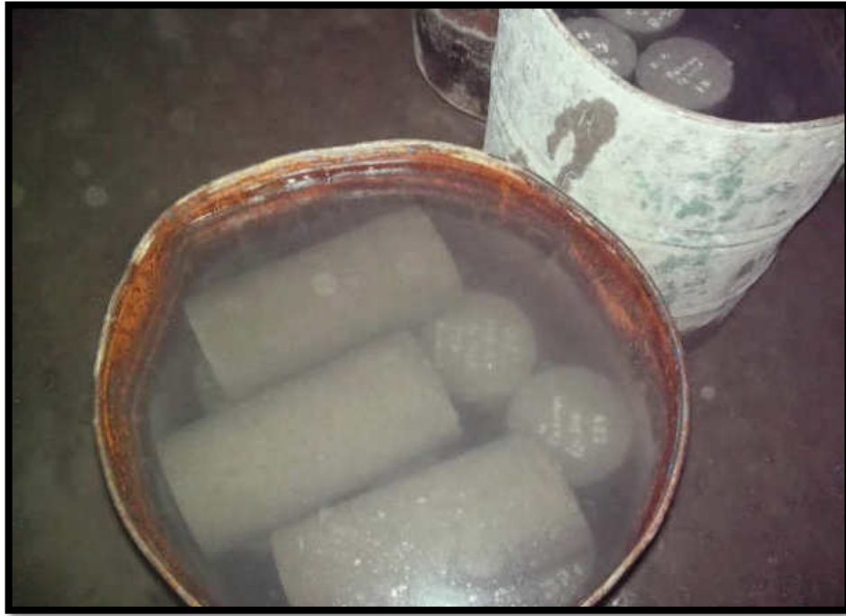
Foto N° 15: Curado del concreto
