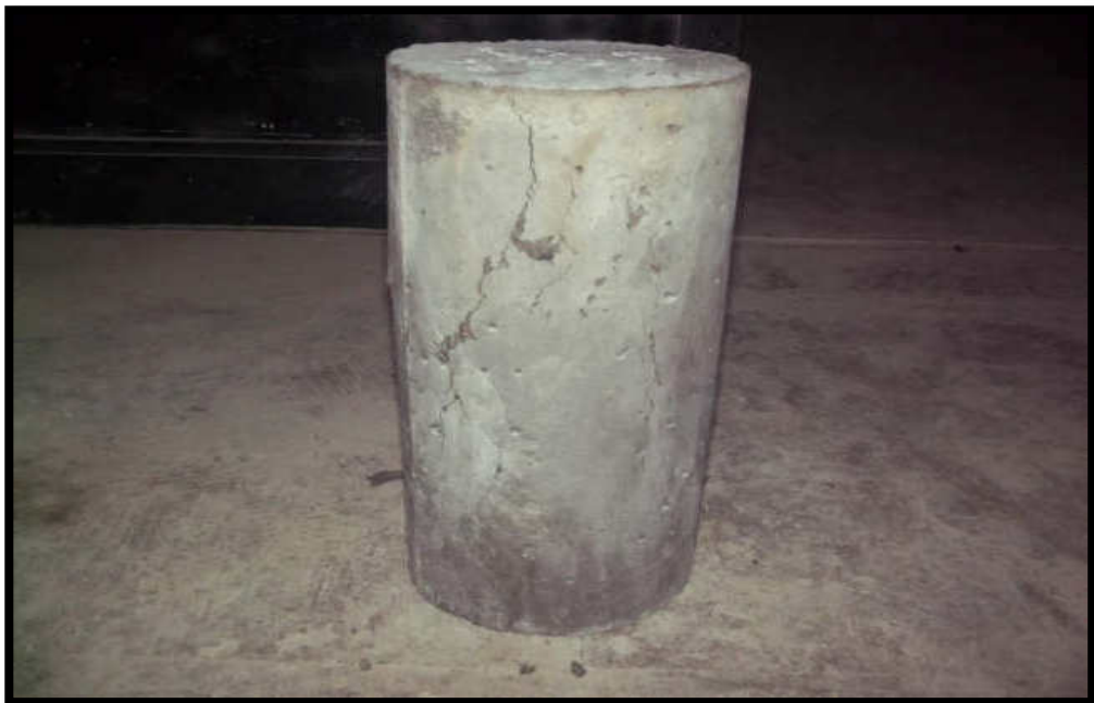
Foto N°18: Falla del concreto después de ser sometido a la resistencia a compresión
