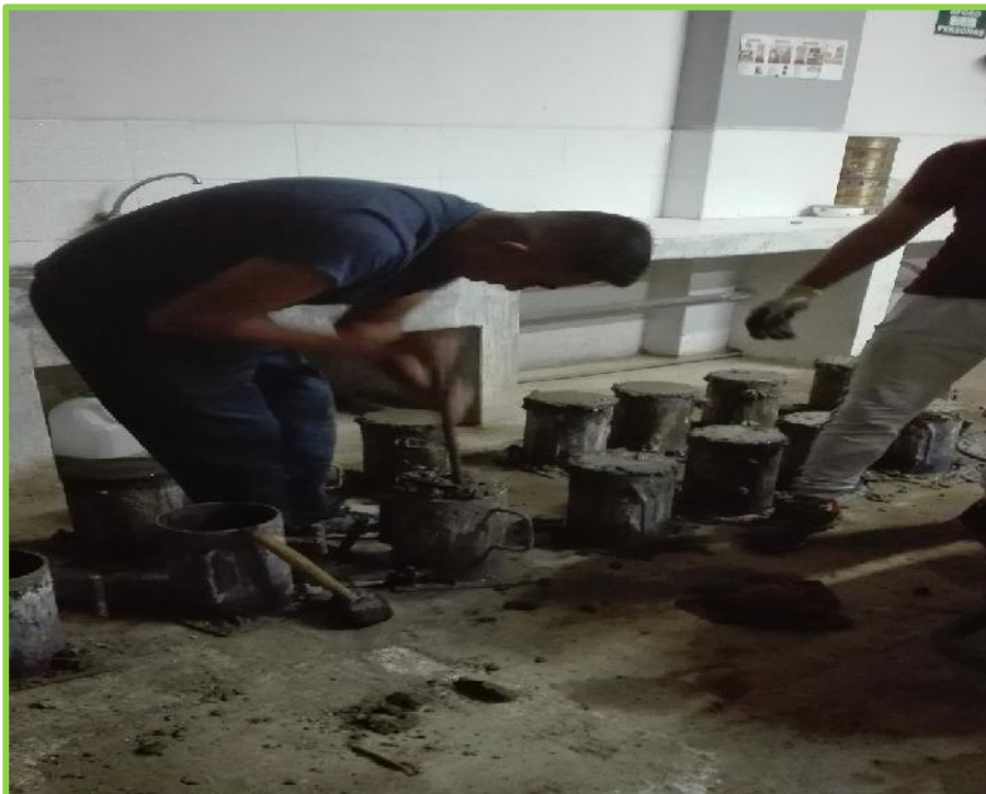
FOTO N°13: Varillado del concreto para reducir vacíos
