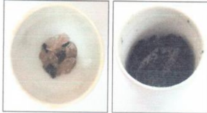
Figura 1. Muestra de resina antes (izquierda) y después (derecha) de calcinar.
