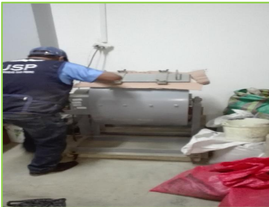
FOTO N°9: Realizando el ensayo para hallar la Resistencia al Desgaste de Agregado Grueso por Abrasión e Impacto en la Máquina de los Ángeles
