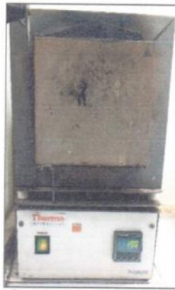
Figura 2. Mufla eléctrica Thermolyne.
