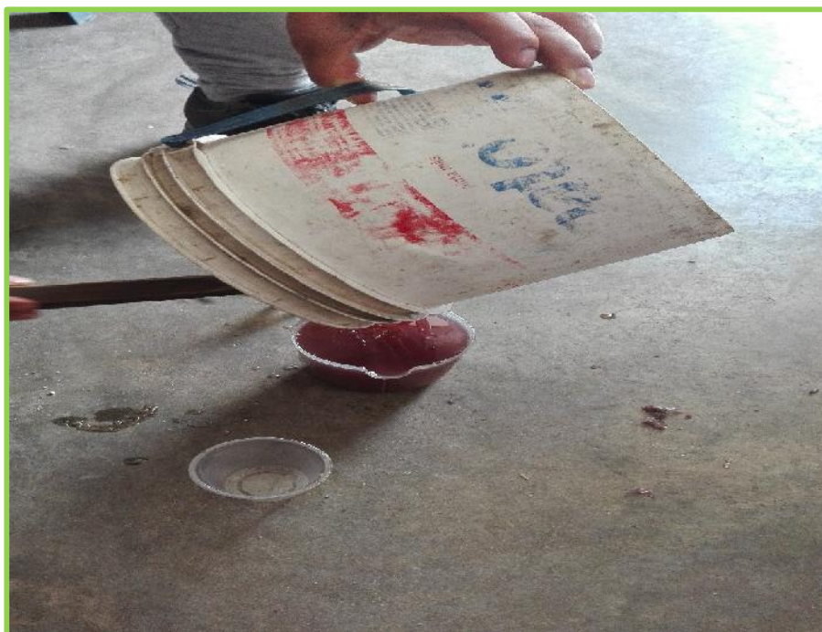
FOTO N°2: Mezcla de la Resina Liquida y el Catalizador
