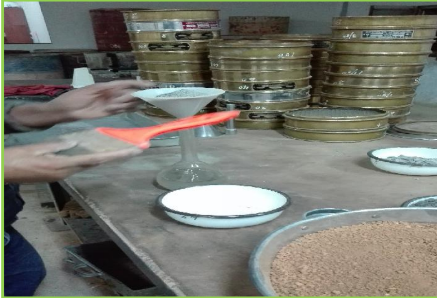
FOTO N°8: Realizando el ensayo para hallar la Gravedad Especifica del Agregado Fino
