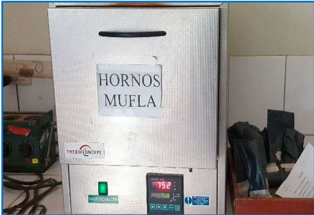
Foto 3: Calcinación de Ichu y la Cáscara de Huevo – Horno Mufla a 360°C y 530°C Fuente: Elaboración propia
