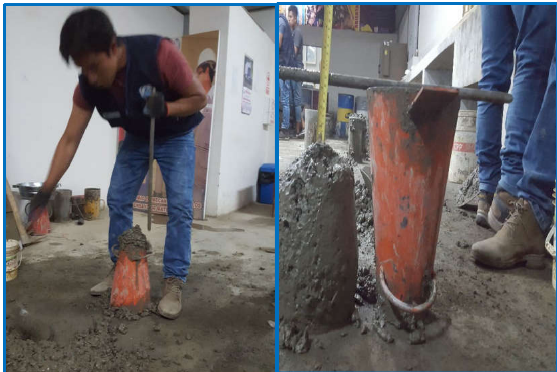
Foto 10: Slump Fuente: Elaboración propia
