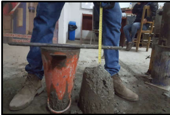
Figura N° 3: Medida de la Consistencia del Concreto – Cono de Abrams
