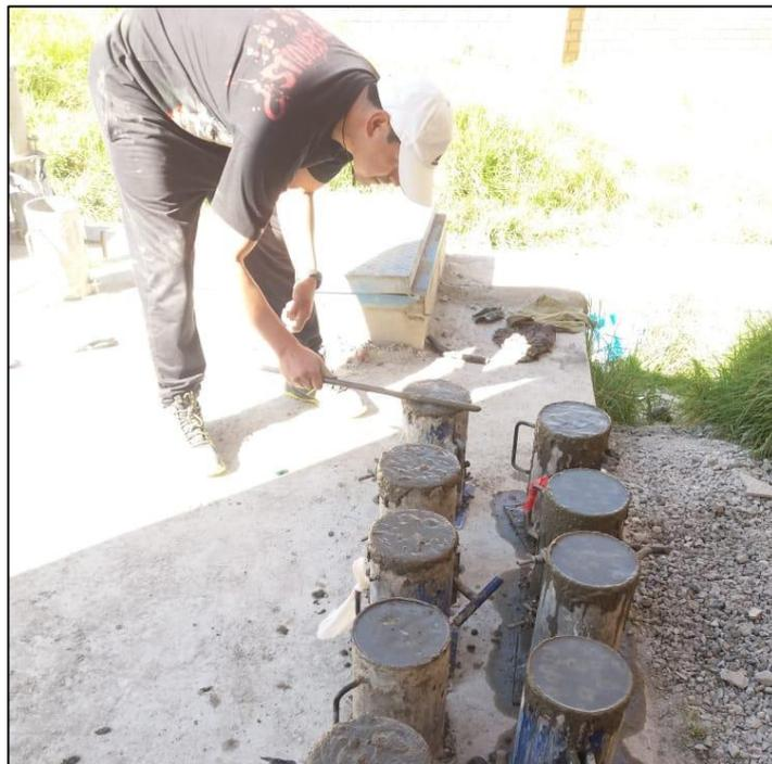
**Fotografía N°14:** enrasado y rotulado de las probetas de concreto.
