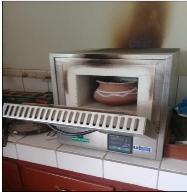
**Fotografía N°09:** Quemado de rastrojo de quinua en horno mufla.
