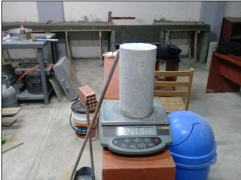
**Fotografía N°17:** Pesaje de probetas de concreto con balanza electrónica.
