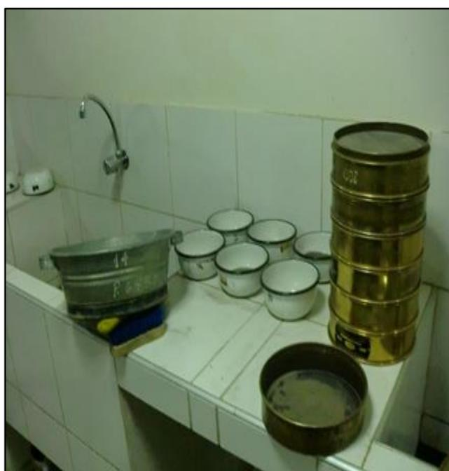
**Fotografía N°06:** Proceso de tamizado de agregado fino.
