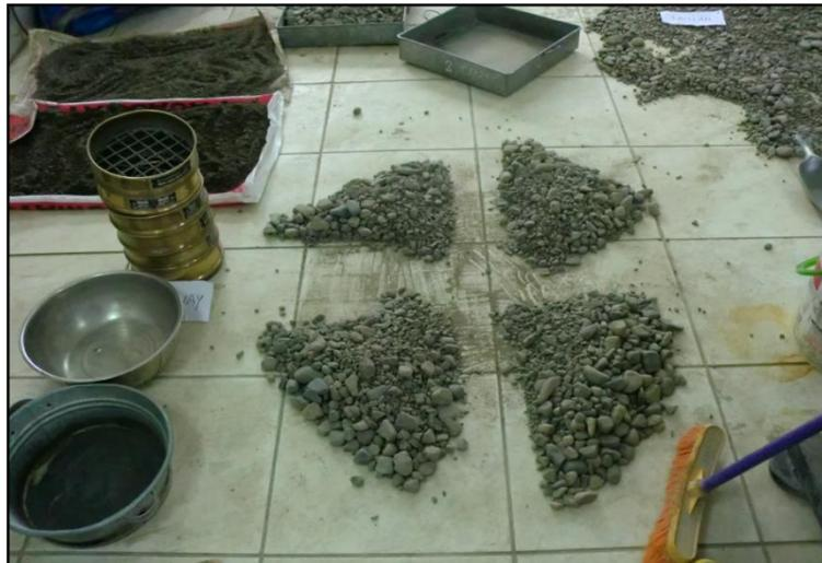
**Fotografía N°04:** Método de cuarteo para determinar las propiedades físicas del agregado grueso.
