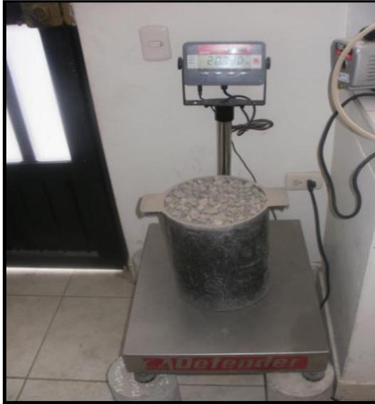
**Fotografía N°03:** Ensayo de peso unitario compactado del agregado grueso en laboratorio.
