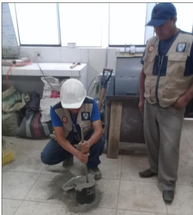
**Fotografía N°05:** Varillado de agregado fino.
