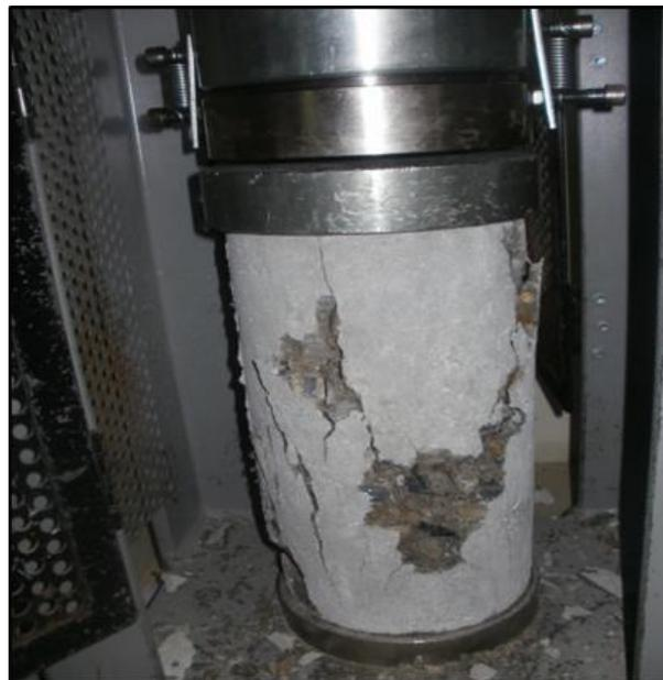
**Fotografía N°18:** Responsable de laboratorio inspeccionando las roturas de probetas
