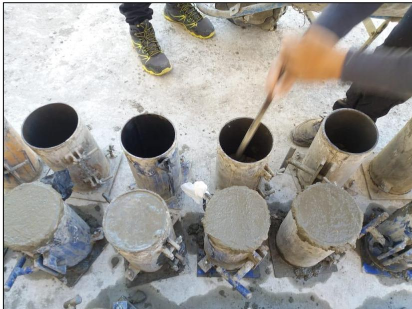
**Fotografía N°12:** Varillado del concreto 25 golpes por capa.
