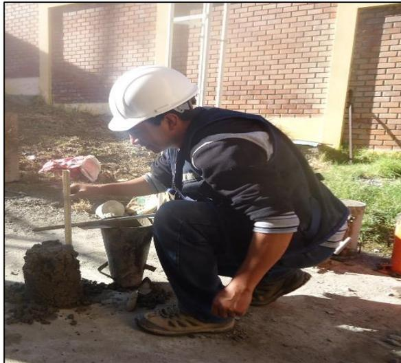
**Fotografía N°13:** Comprobando la medida del asentamiento “prueba de slump”.
