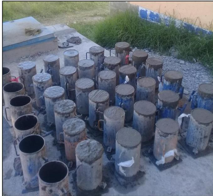
**Fotografía N°15:** Probetas de concreto para la tesis las cuales se mantuvieron cubiertas por 24 horas antes de desencofrar y posteriormente sumergirlas en agua.
