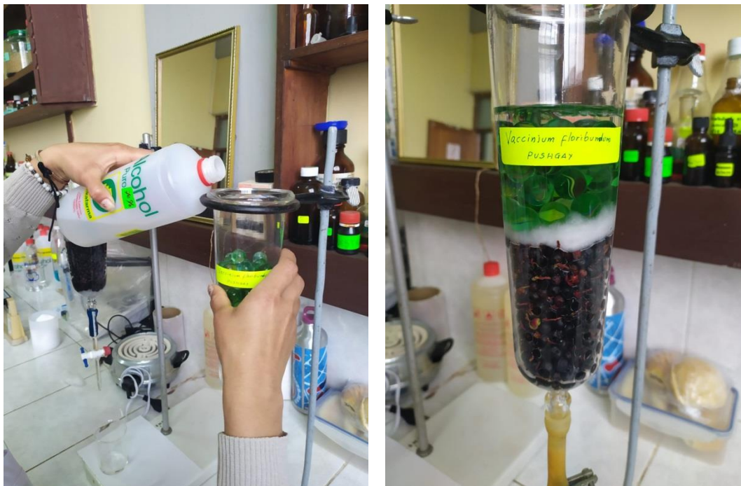
Fig. 10 y 11. Proceso de lixiviación de Vaccinium floribundum .
