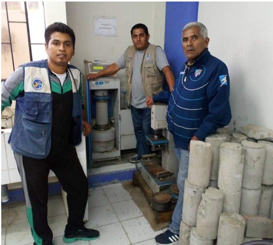
Foto N° 29: Se realizó la rotura de Probetas a los 7, 14,28 y 45 del experimental de 20% y 40%.
