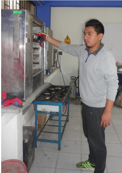
Foto N° 07: Muestra de arena al horno durante 24hrs.
