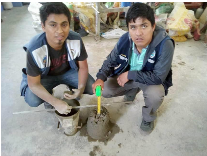
Foto N° 25: Obtuvo un slump de 3.5" en mi concreto experimental del 20%.
