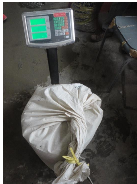
Foto N° 17: Pesaje del agregado fino
