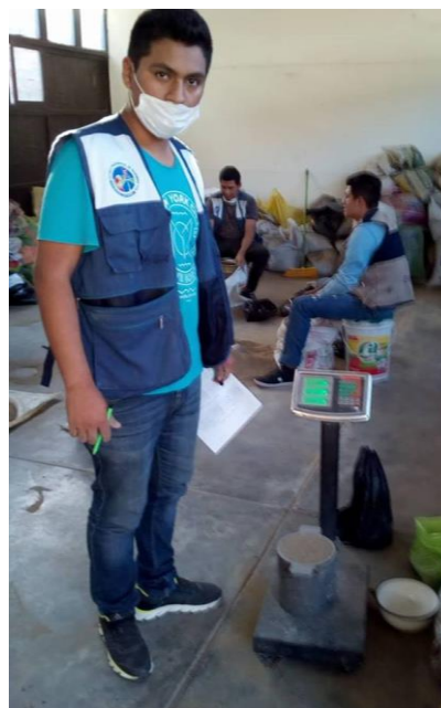
Foto N° 08: Pesando el molde + arena. Serepite el procedimiento 3 veces.
