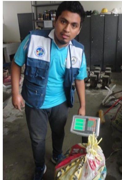
Foto N° 15: Pesando el agregado grueso.
