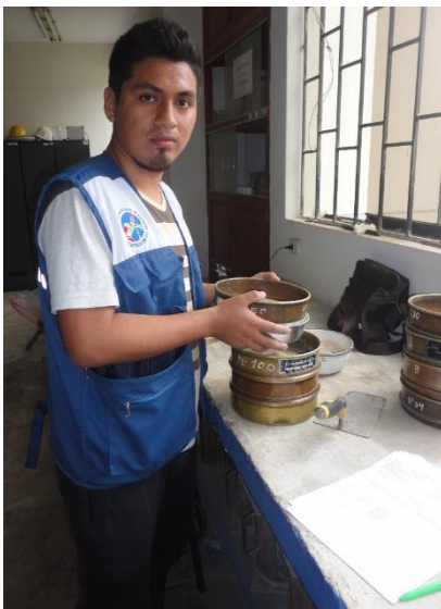
Foto N° 06: El agregado fino pasa por las diferentes mallas.
