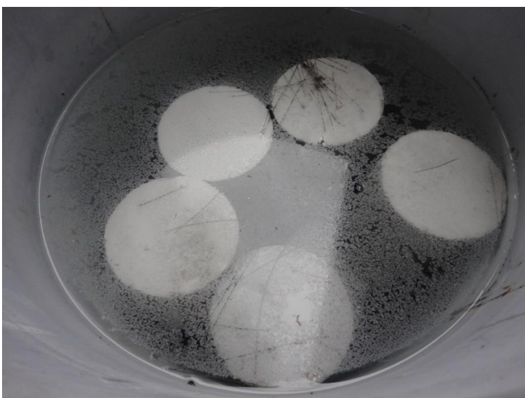
Foto N° 22: Se realiza el curado de probetas, para luego hacer la resistencia a la compresión a los 7, 14, y 28 días.
