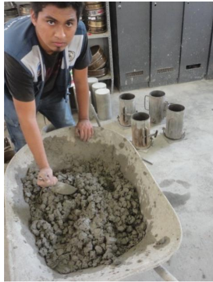
Foto N° 24: Elaboración de las probetas con sustitución de 5% de cenizas de Cáscara de arroz y de 15% de carbón.
