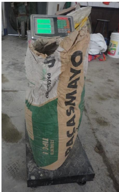
Foto N° 16: Pesaje del cemento
