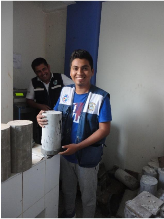
Foto N° 28: Se realizó la rotura de Probetas a los 7, 14,28 y 45 del patrón.
