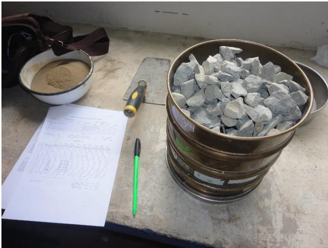
Foto N° 05: Tamizando y realizando los apuntes del agregado grueso.
