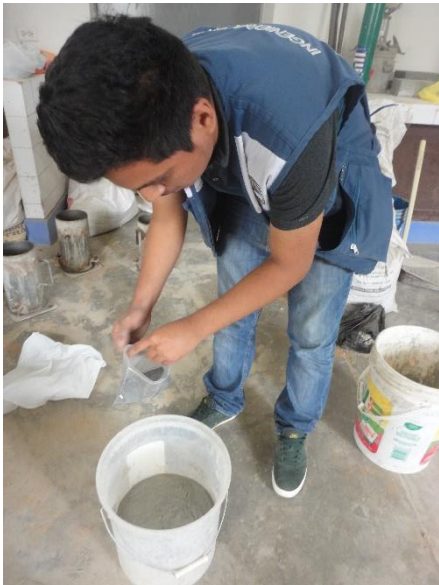
Foto N° 23: Se procede a combinar las cenizas con el cemento.
