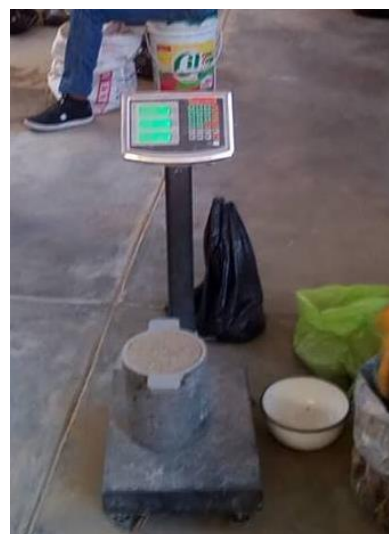
Foto N° 09: Se pesa el molde + muestra compactada.
