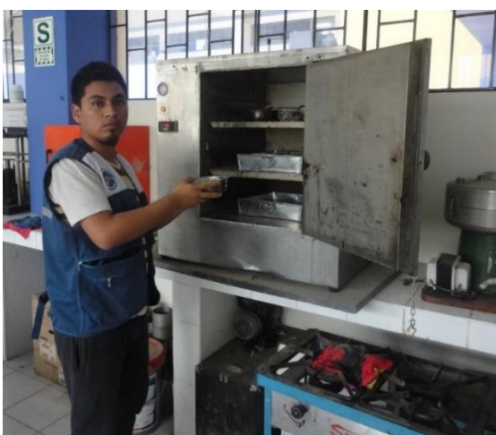
Foto N° 05: Se pone la muestra al horno por 24hrs.
