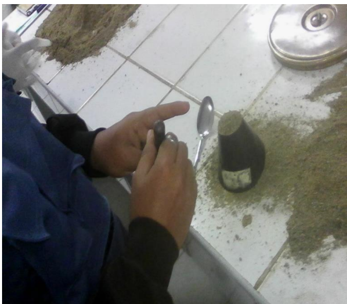
Foto N° 10: Mediante el cono, se hace la prueba de humedad.
