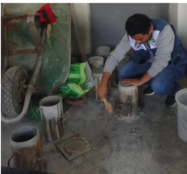
Foto N° 21: Desencoframamos las probetas del patrón.
