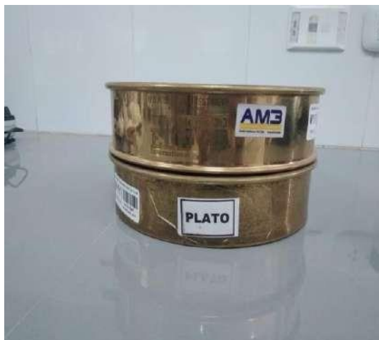
Figura n°13 y 14: Tamizado de la ceniza de concha de coquina mediante la malla N°200
