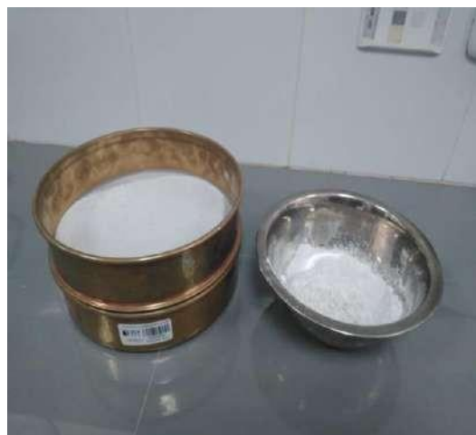
Figura n°13 y 14: Tamizado de la ceniza de concha de coquina mediante la malla N°200
