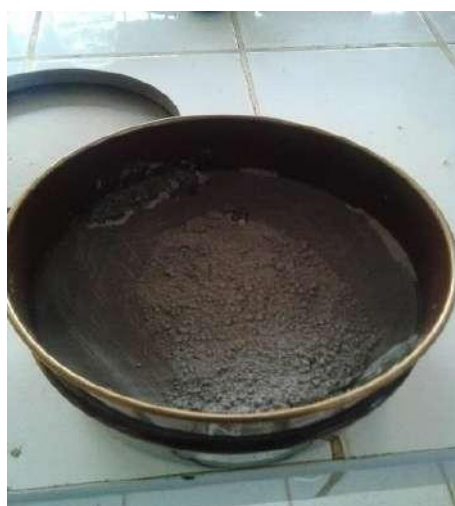
Figura n°10: Tamizando en la malla N°200 el material sustituto.
