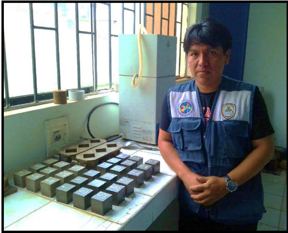
Foto 16. Desencofrado de los Morteros Patrón y Experimental
