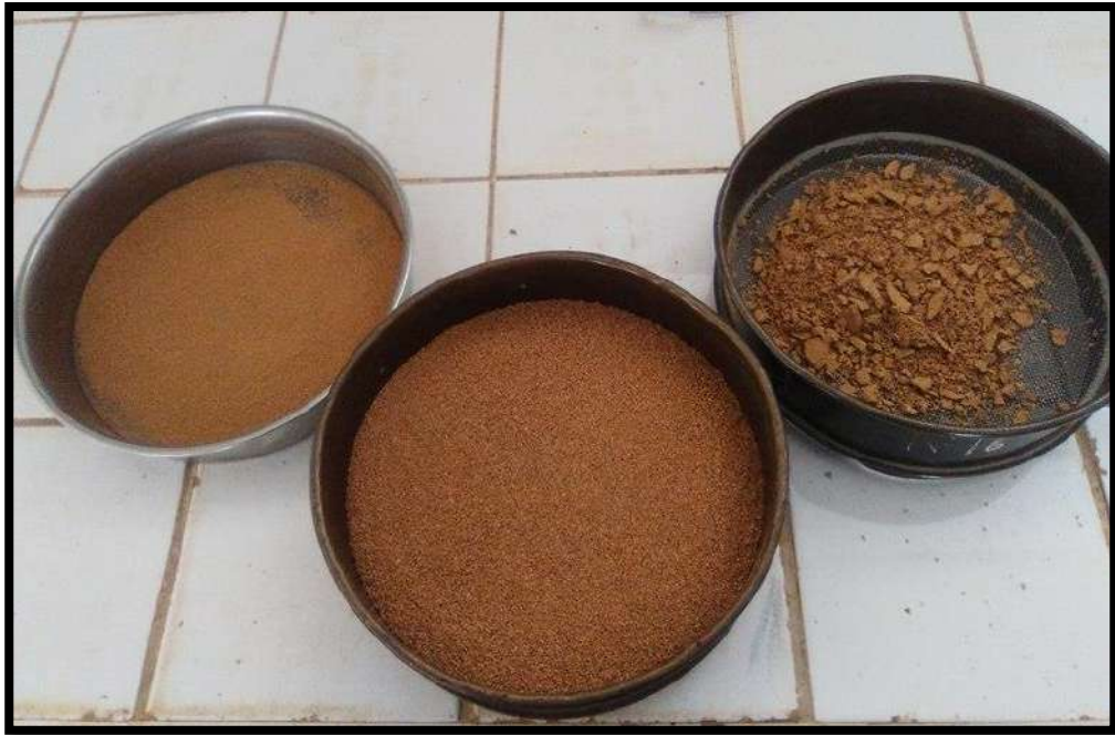
Foto 7. Corcho Gradado – Retenido de la Malla N°30 y pasante de la Malla N° 16
