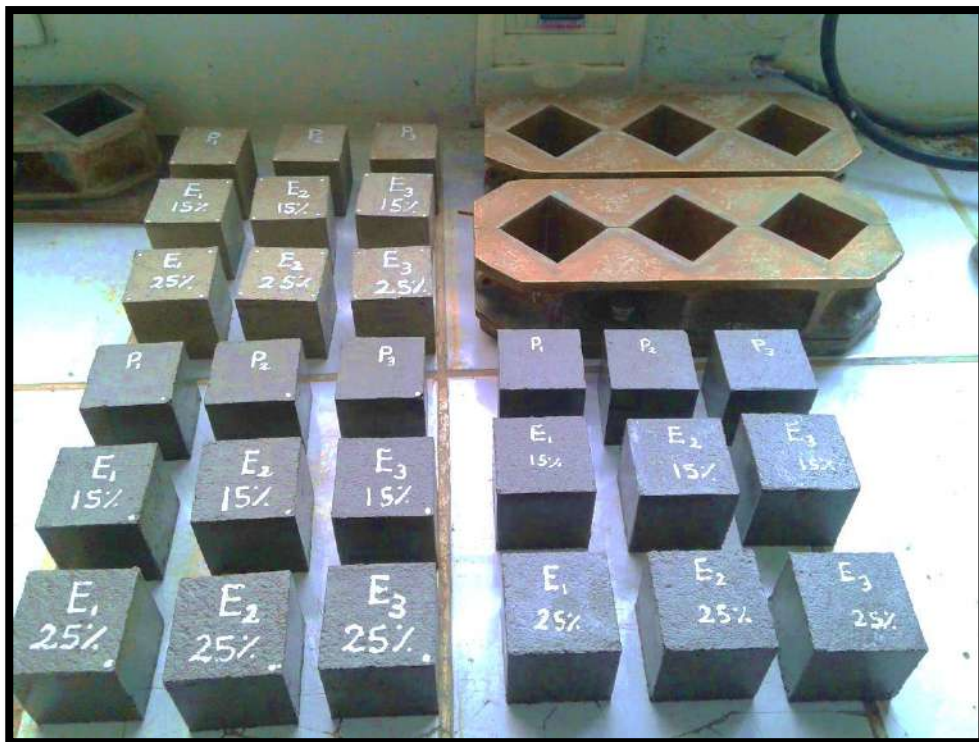
Foto17. Morteros Listos para el Curado
