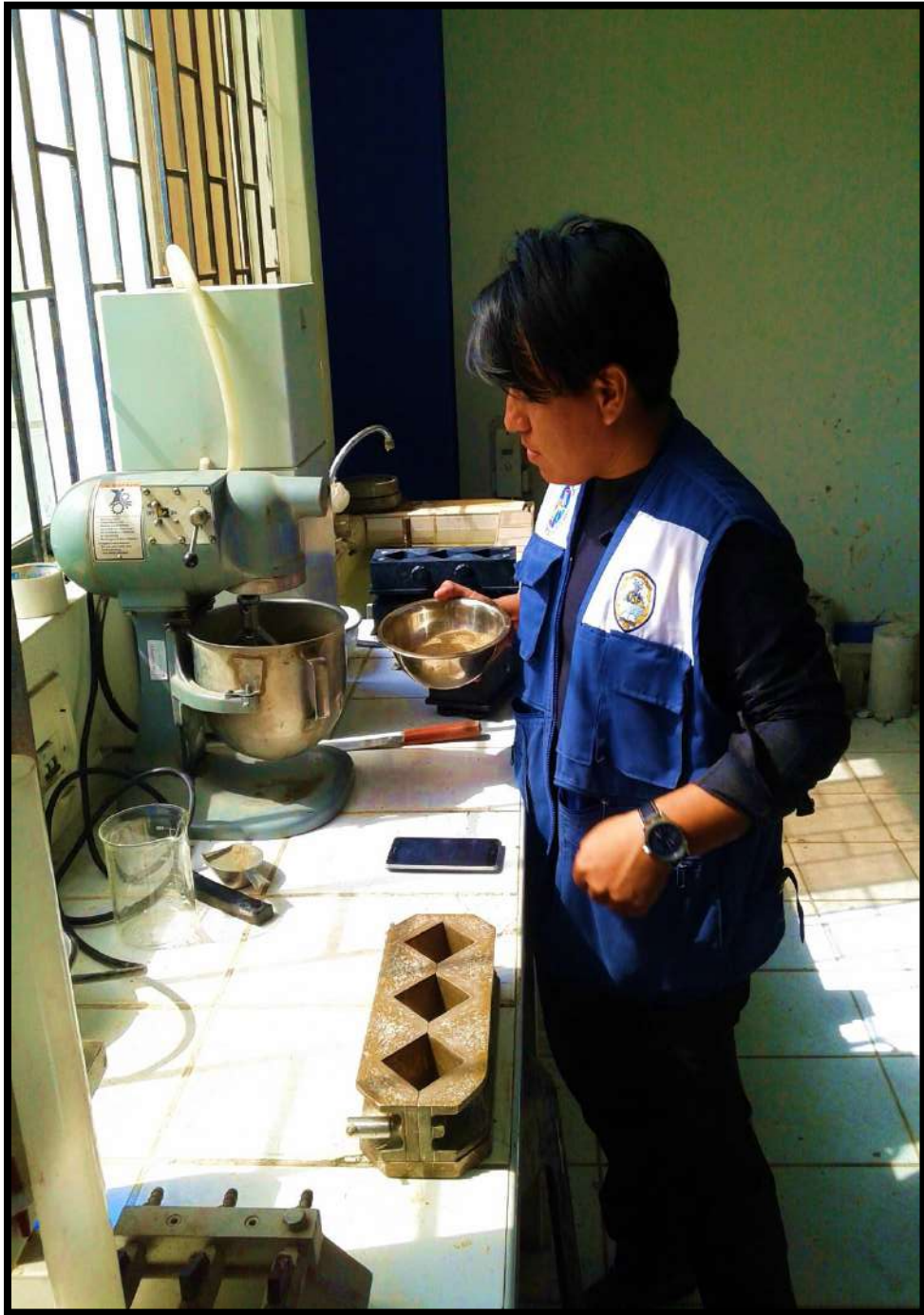
Foto 12. Preparación de la Mezcla de Mortero
