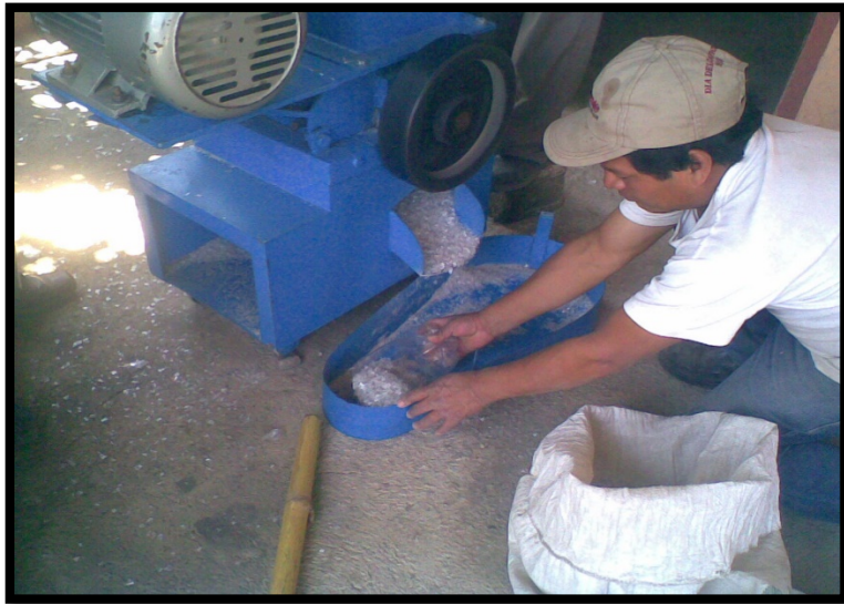
Foto 3: Triturado del Plástico Reciclado Fuente: Elaboración propia
