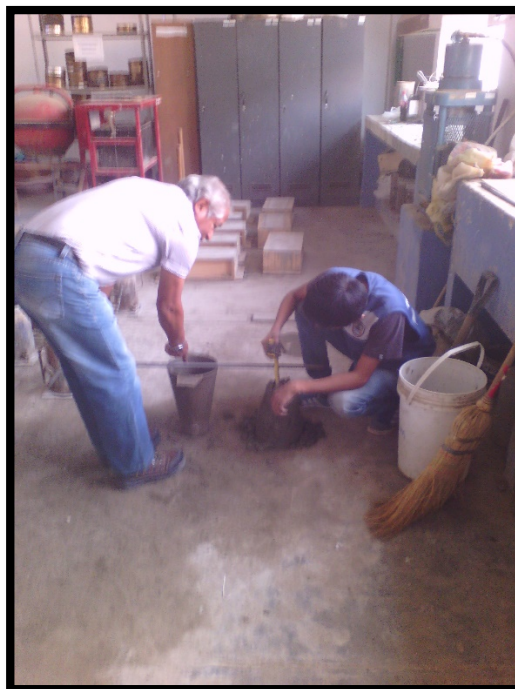
Foto 10: Medición de Slump (3 a 4") Fuente: Elaboración propia
