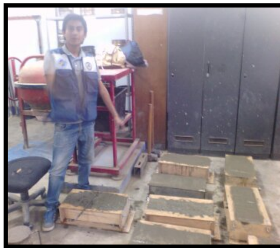
Figura 12: Elaboración de las Vigas Patrón Fuente: Laboratorio de la USP
