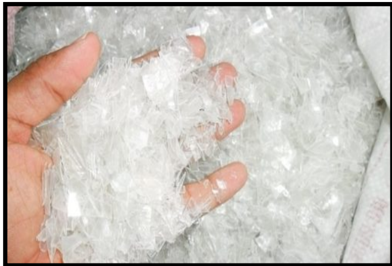
Foto 4: Molido del Plástico Reciclado Fuente: Elaboración propia
