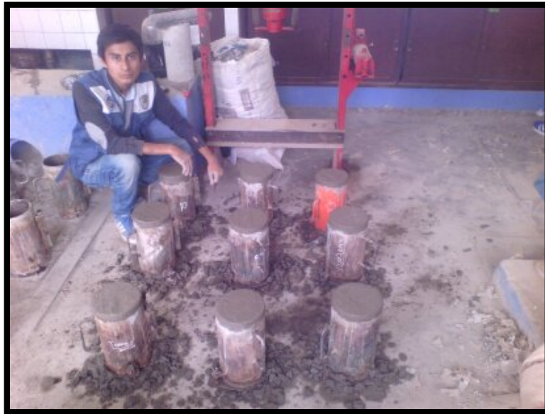
Foto 11: Final de colocado de concreto Fuente: Elaboración propia
