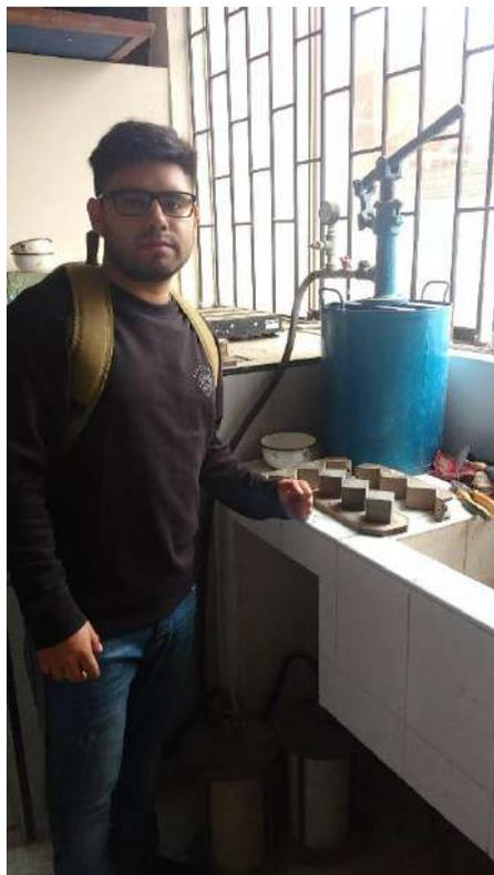
Imagen 14: En la presente imagen procedemos a realizar el desencofrado de los morteros en el laboratorio de suelos de la Universidad San Pedro
