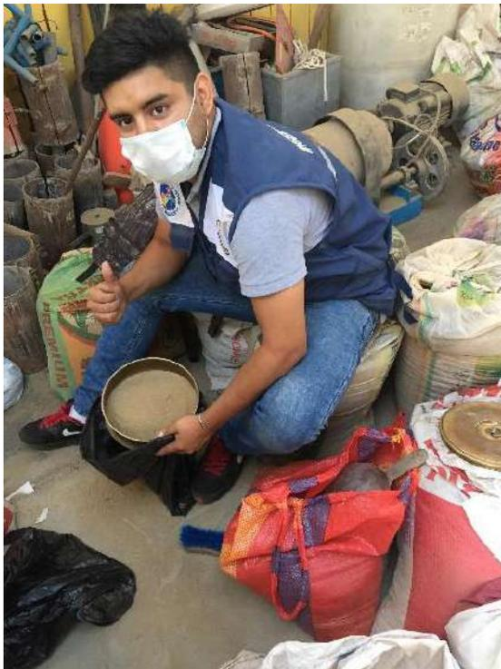
Imagen 12: En la presente imagen procedemos a tamizar el agregado grueso pasando por las mallas #4, #8, #16, #30, #50, #100, #200 para obtener finos y el módulo de fineza.
