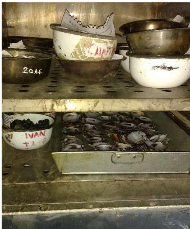
Imagen 07: En la presente imagen realizamos el secado en el horno por 24 horas a una temperatura de 110°C.
