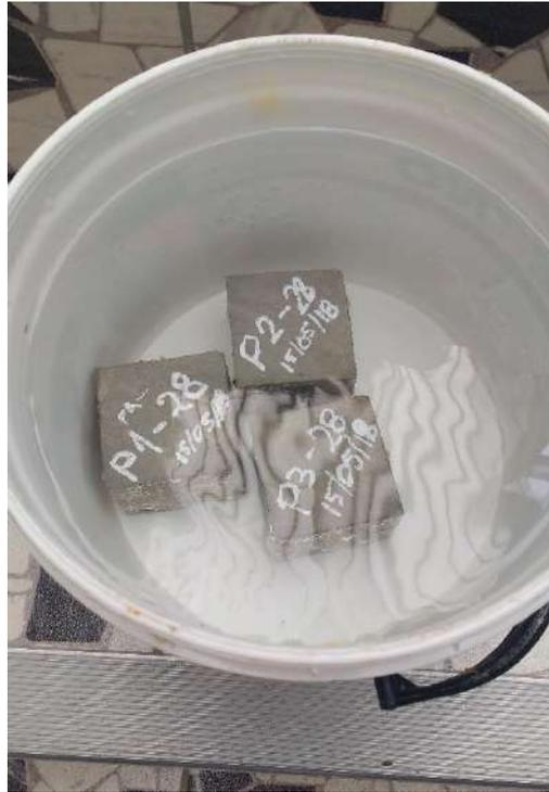
Imagen 15: En la presente imagen observamos el realizado del curado de los morteros patrón y experimental de 3, 7 y 28 días.
