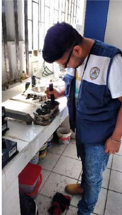
Imagen 13: En la presente imagen observamos el realizado de los morteros patrón y experimental de 3, 7 y 28 días.
