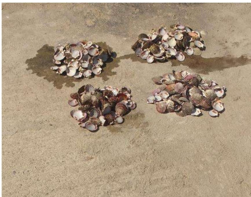
Imagen 06: En la presente imagen realizamos el cuarteo correspondiente, seleccionamos el mejor cuarto y limpiamos nuevamente para poner a remojar y cambiar de agua cada 2 horas por 1 día para despejar el mal olor.
