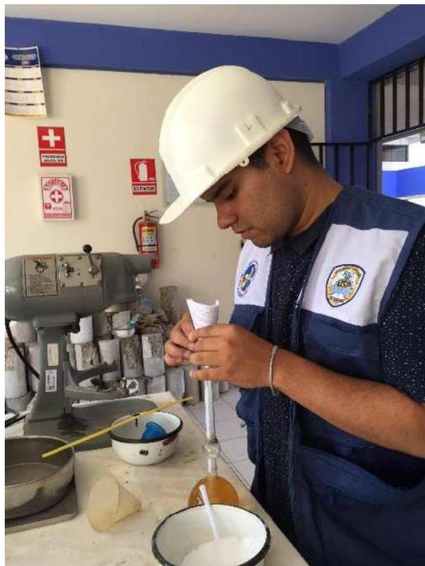
Imagen 16: En la presente imagen observamos el realizado del ensayo de peso específico.
