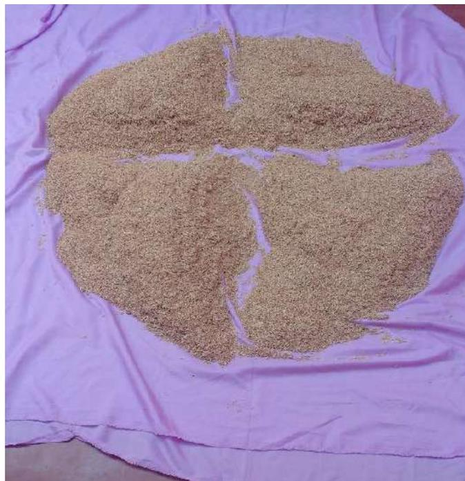
Imagen 02: En la presente imagen realizamos el cuarteo correspondiente 2 veces y seleccionamos el mejor cuarto.
