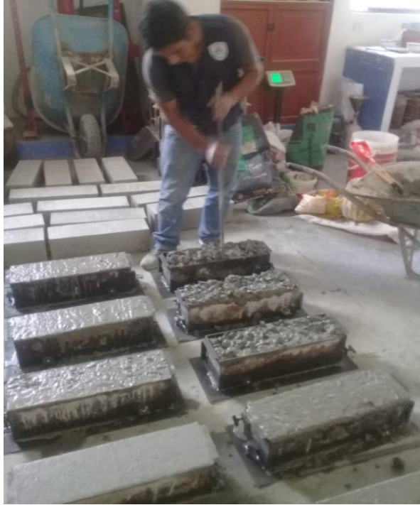
Foto 11. Llenado de las vigas con 3% y 5% de Plástico PET varillando 75 veces.
