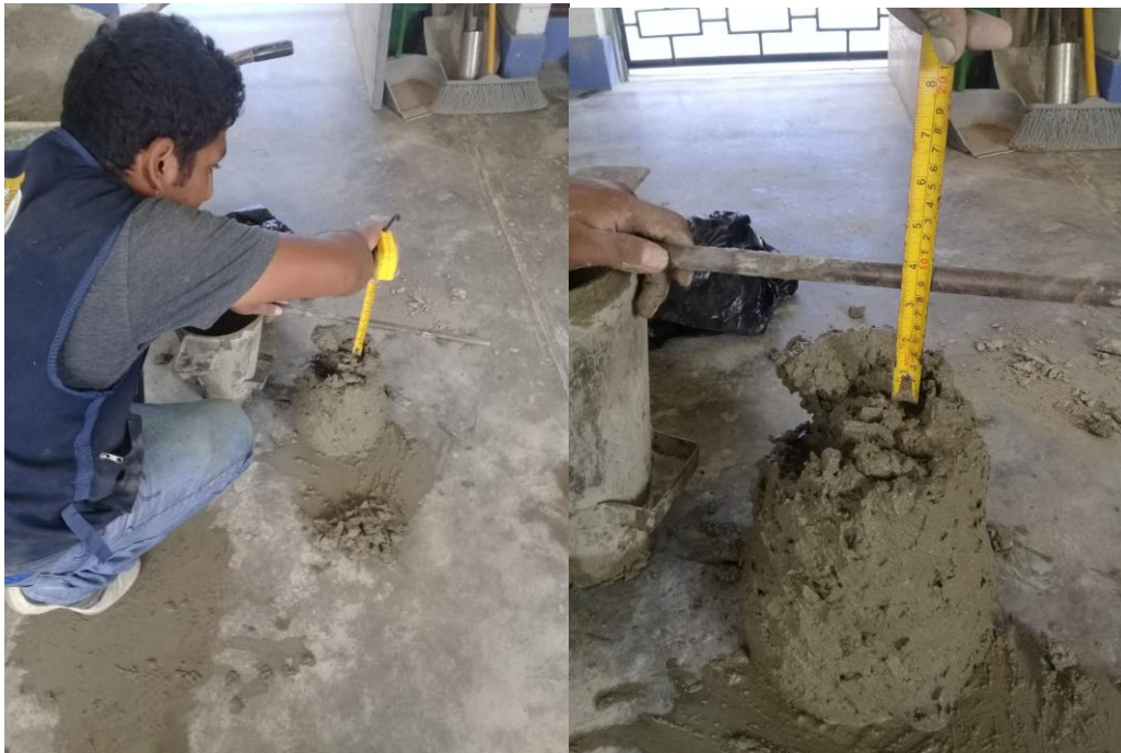
Foto 10. Slump con 3% y 5% del Plástico PET Fuente: El Autor.
