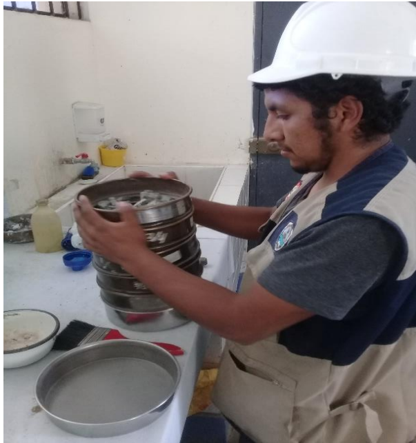
Foto 03. Tamizado de los Agregados.
