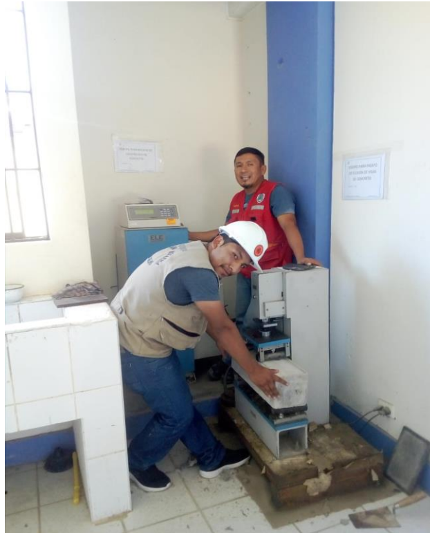
Foto 13. Ensayo a la Resistencia a la Flexión
