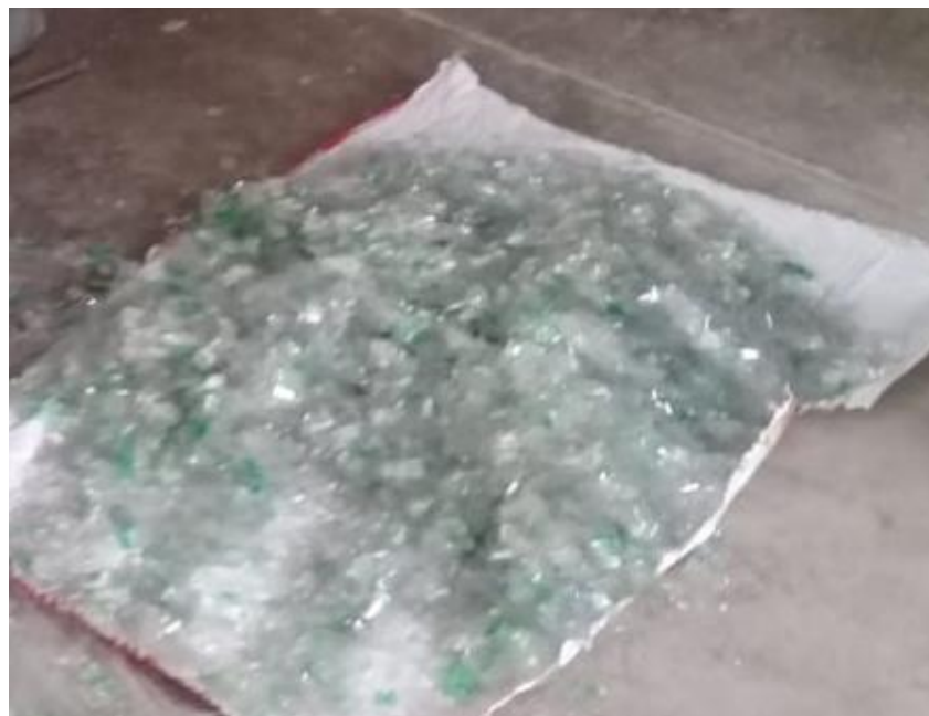
Foto 02. Cortado de los Plásticos PET. Fuente: El Autor.
