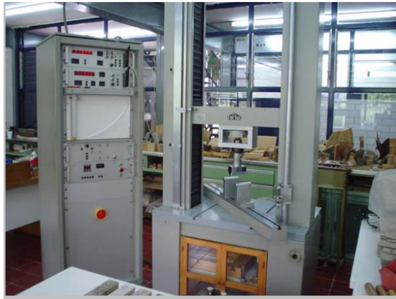
Figura 6. Maquina universal para realizar los ensayos de flexión. Fuente: INECYC. (2009). Control de calidad en el hormigón
