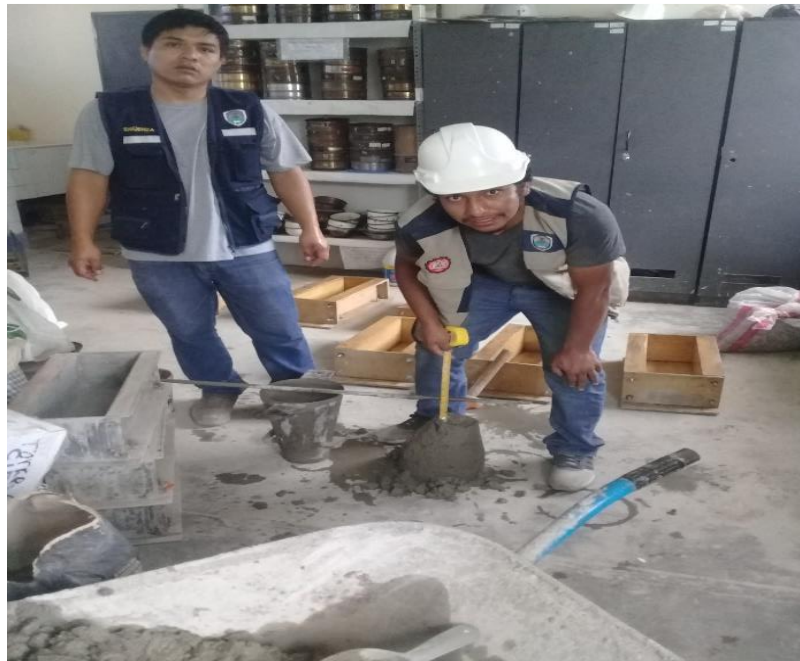
Foto 08. Slump del concreto patrón 3.5''
