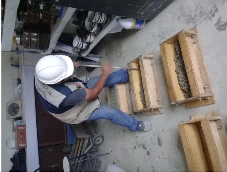
Foto 09. Llenado de las vigas patrones cada 3 unidades Fuente: El Autor.
