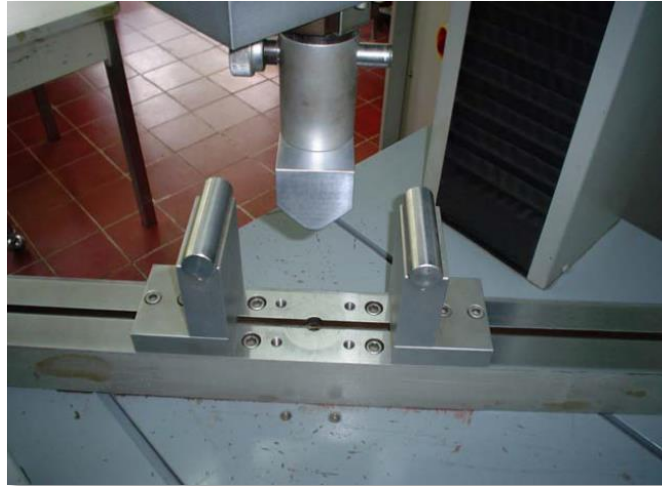
Figura 8: Soporte donde se coloca la probeta para la aplicación de la carga.
