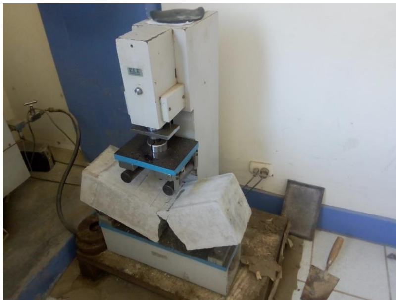
Foto 14. Rotura de viga
