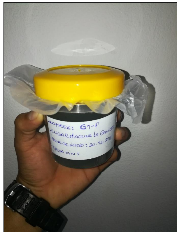
Fotografía 13: Recipientes de muestreo patrón en Laguna La Gaviota (G1-P) con capacidad de 250 ml enviada a SEDALIB S.A.
