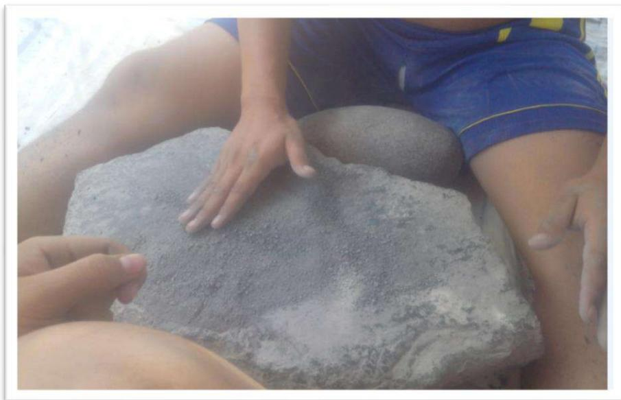
Foto N° 08: esquisto pulverizado para posteriormente someterlo al proceso de tamizado por malla N° 200.
