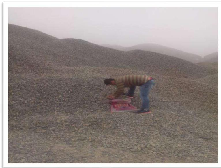
Foto N° 02: extrayendo material (agregado fino) de la cantera
