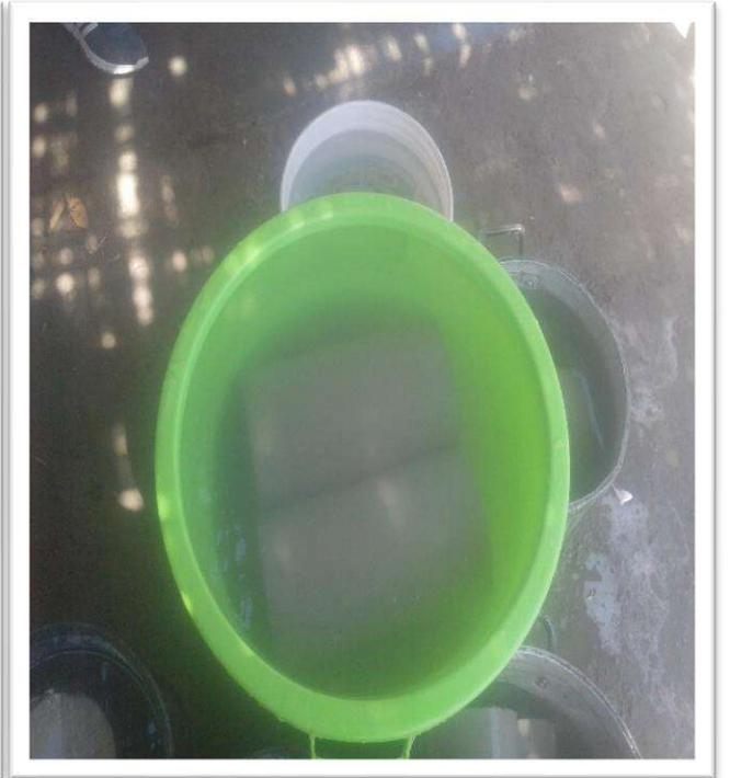
Foto N° 34 y N° 35: Curado de probetas patrón y experimentales en 7 y 10%, se utilizó cilindros de plástico y agua potable.
