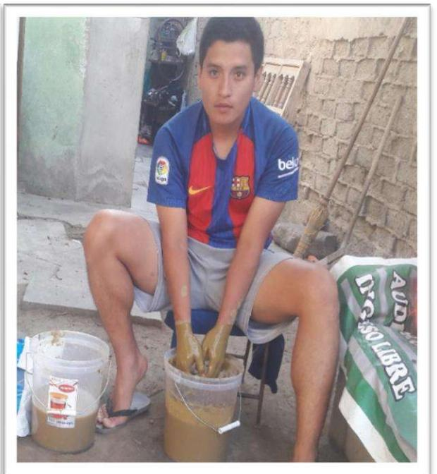
Foto N° 11 y N° 12: lavado de arcilla hasta dejarlo líquido, posteriormente se cola y luego se deja que se asiente para luego sacar el agua de la parte superior.
