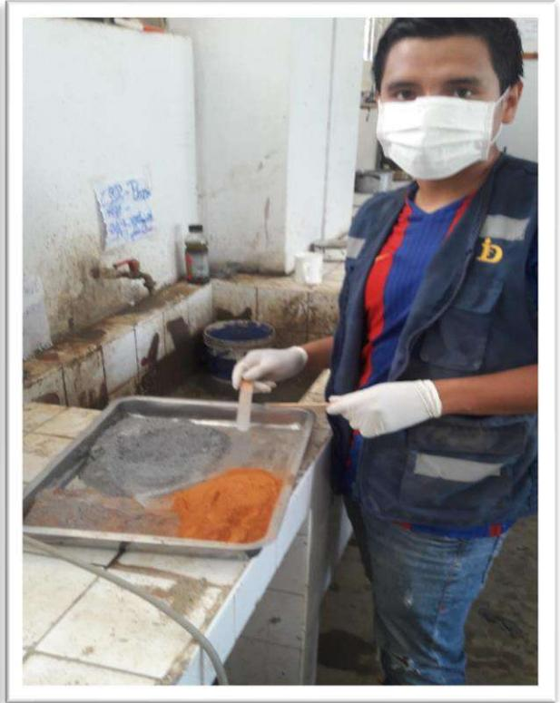
Foto N° 22 y N° 23: Combinación homogénea de arcilla y esquisto, para posteriormente combinarlo con el cemento para agregarlo a la mezcla de concreto.
