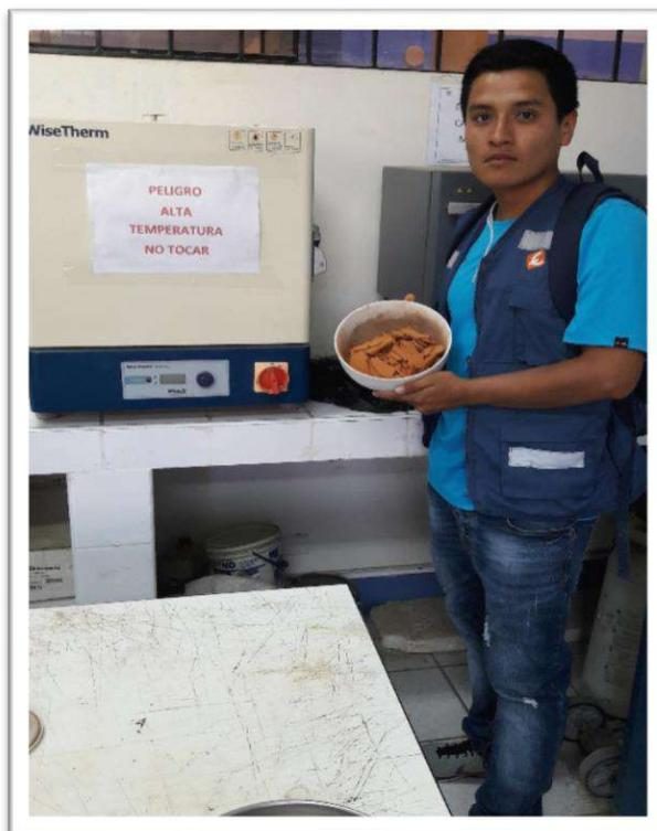
Foto N° 18: se aprecia la arcilla ya activada en el horno, lo cual se puede apreciar un cambio de color de amarillo a rojo.
