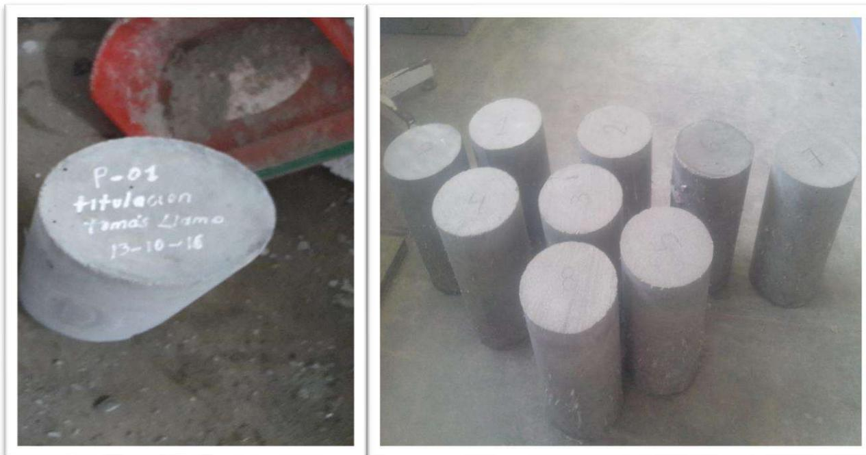
Foto N° 31 y N° 32: Desencofrado de Probetas patrón y experimentales, en la parte superior se describió el número de probetas, nombre y fecha de vaciado.
