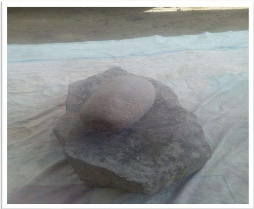
Foto N° 06: batan y chungos empleados en el proceso de pulverización manual de piedra esquisto.
