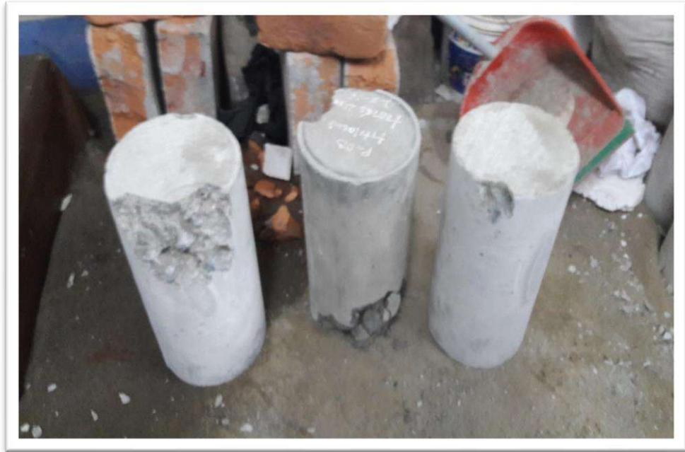
Foto N° 38: Se puede apreciar la rotura de probetas patrón a los 7 días ensayadas a la resistencia a la compresión, donde se puede apreciar la grietas y roturas en la parte superior e inferior de las probetas.
