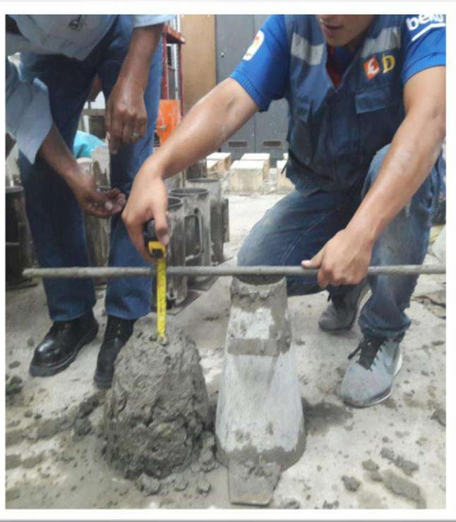
Foto N° 27 y N° 28: Medida de SLUMP de la mezcla de concreto patrón y experimental en 7 y 10%, la cual fue de patrón de 3.35", experimental en 7% de 3.55" y de 10% de 3.60".
