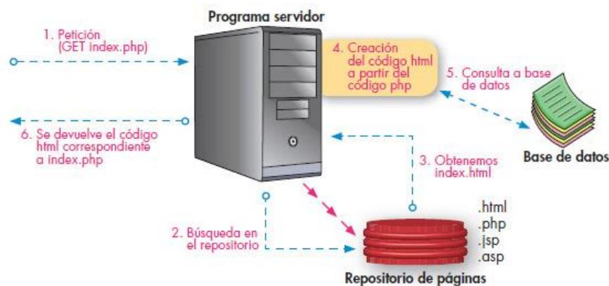
Figura 1: Esquema básico del funcionamiento del servicio web
