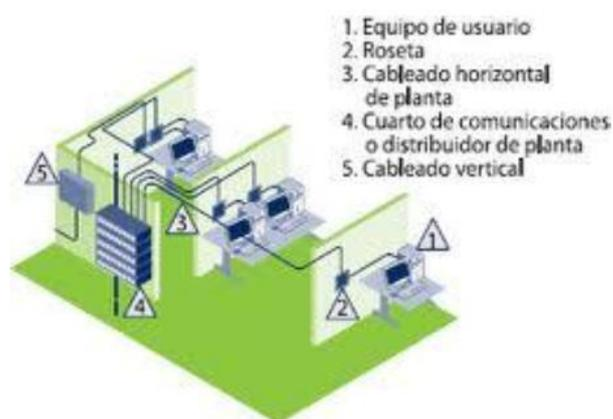
Figura N° 10. Partes de un Sistema de Cableado Estructurado
