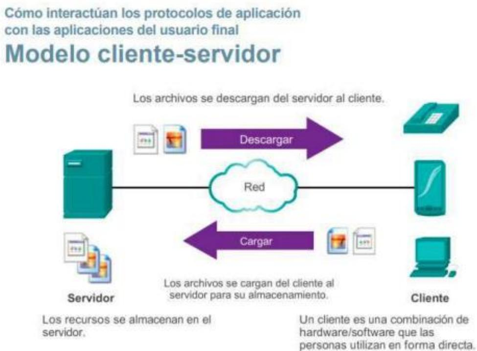
Figura 1: Diagrama de conexión entre cliente y servidor. (Coto, 2008)
