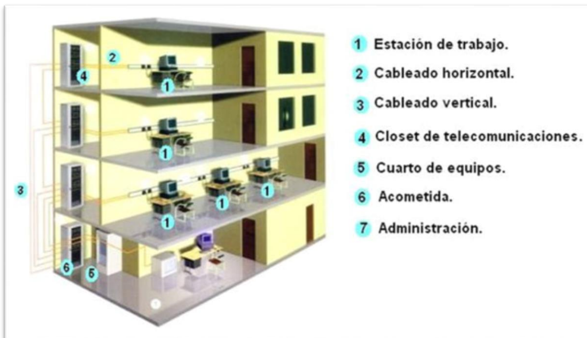
Figura 02. Elementos de los Sistemas de Cableado Estructurado
