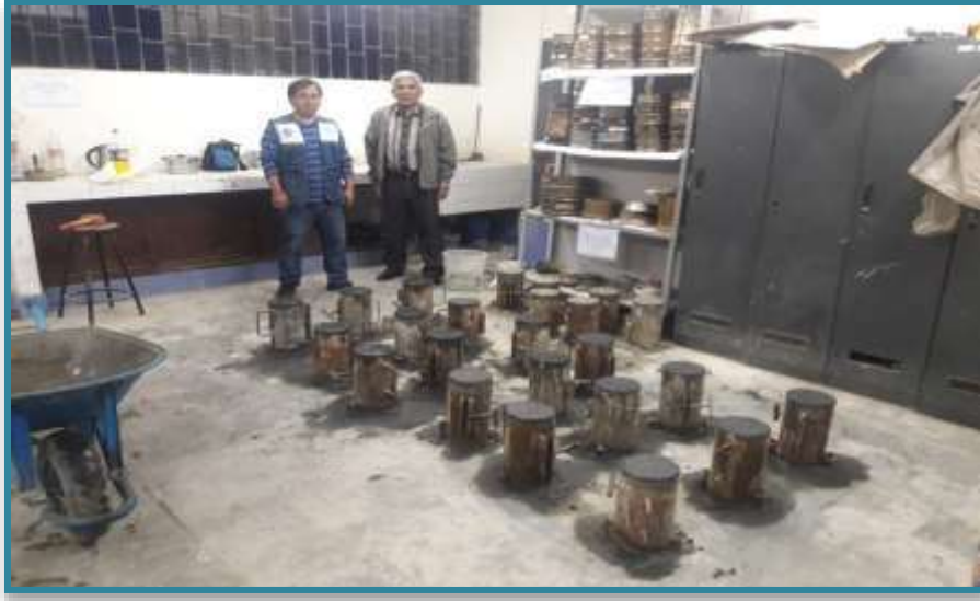
FOTO N°18: probetas encofradas y enrasadas listas para secar
