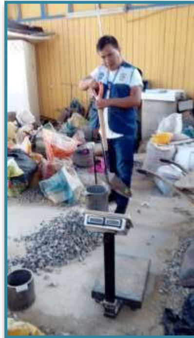
FOTO N°05 y 06: Realizando el ensayo de Peso Unitario de los Agregados
