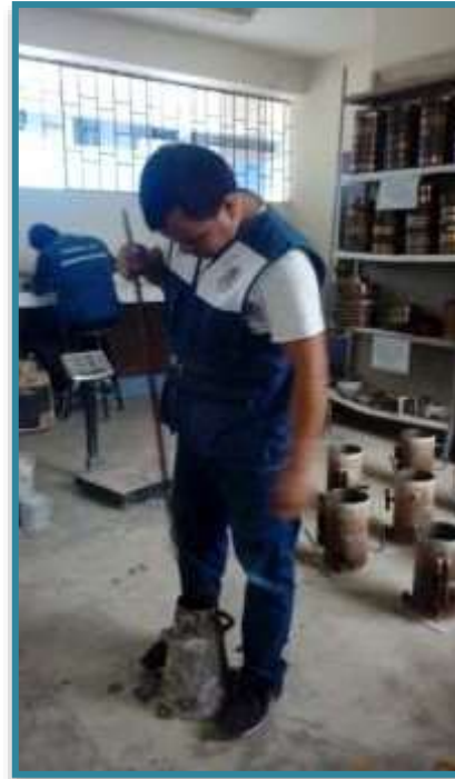
FOTO N°07 y 08: Preparando la mezcla y realizando el SLUMP, de la mezcla
