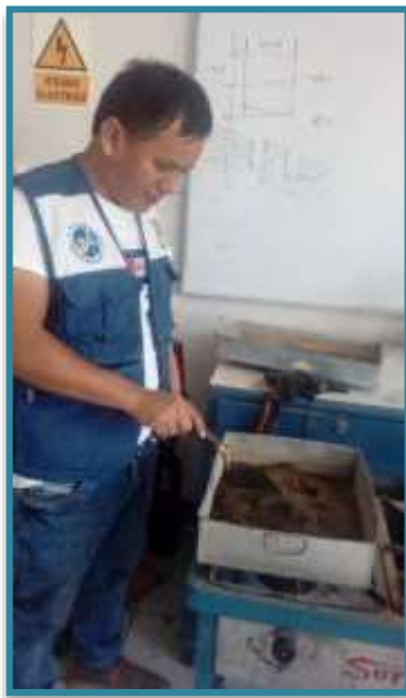
FOTO N°04: Realizando el ensayo de Humedad de los agregados
