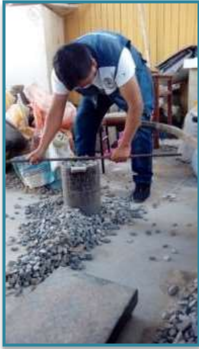
FOTO N°05 y 06: Realizando el ensayo de Peso Unitario de los Agregados
