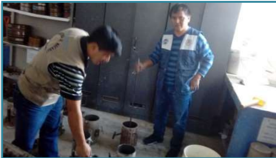
FOTO N°15: Realizando el llenado y apisonado de las probetas experimentales al 20% y 25% de sustitución de Cenizas Volátiles
