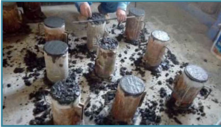
FOTO N°16: Terminando con el llenado y enrasado de las probetas experimentales al 20% y 25% de sustitución de Cenizas Volátiles
