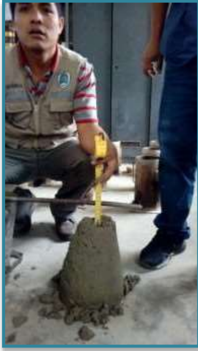
FOTO N°09 y 10: midiendo el SLUMP, y llenando las probetas patrón
