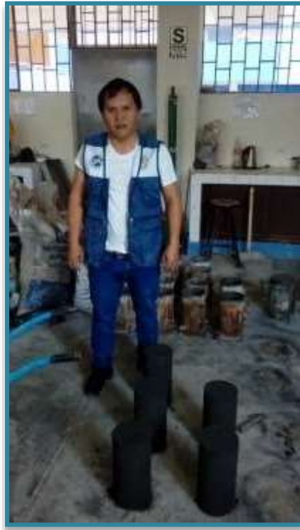
FOTO N°19: Desencofrando las probetas experimentales con cenizas volátiles al 20% y 25% de sustitución listas
