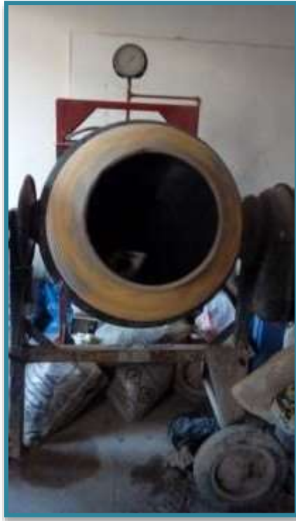
FOTO N°14: ensayando realizando la mezcla para las probetas experimentales
