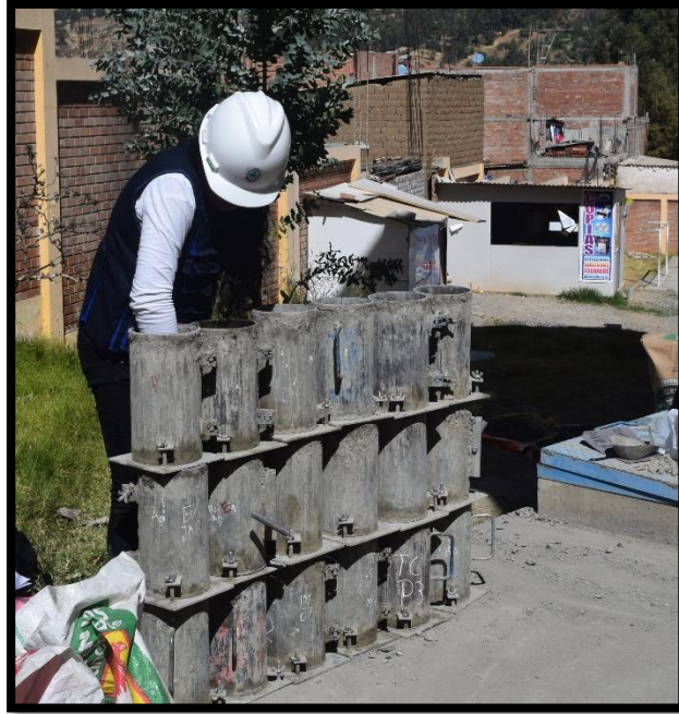
Ilustración 05: preparación y limpieza de moldes.
