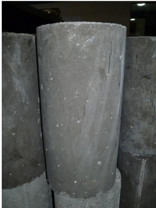
Imagen N° 014. Fisuras verticales encolumnadas a través de ambos extremos, conos mal formados.
