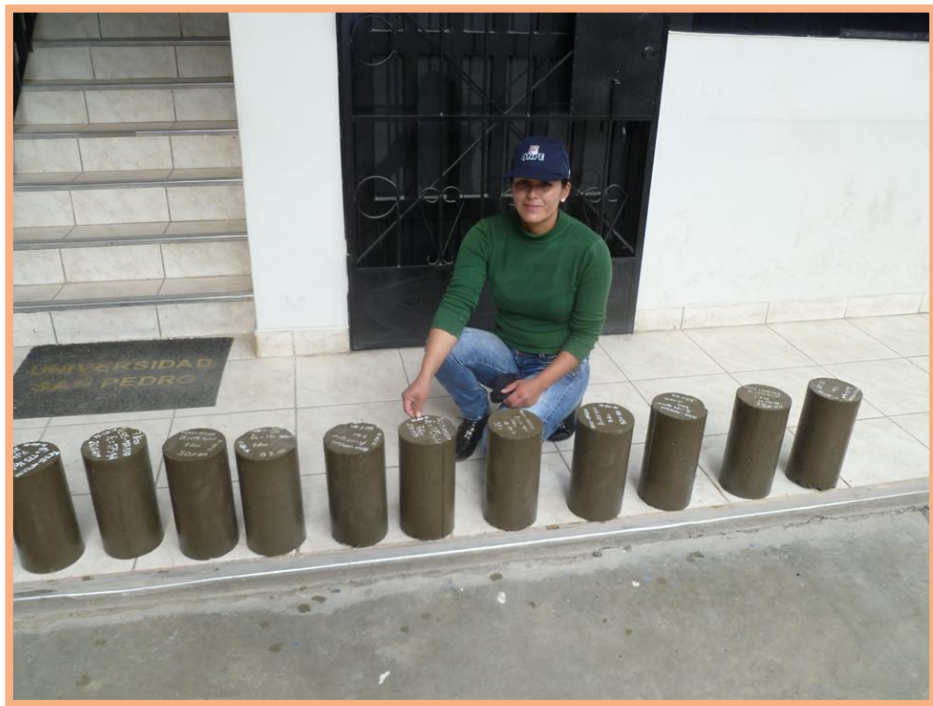
Imagen N° 012. Probetas listas para el ensayo a la compresión.
