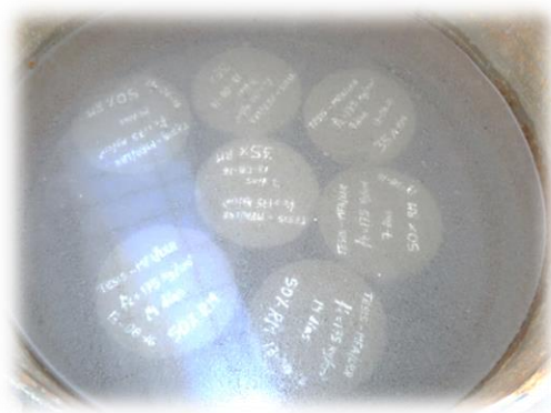
Foto N° 04. Curado de probetas de concreto
