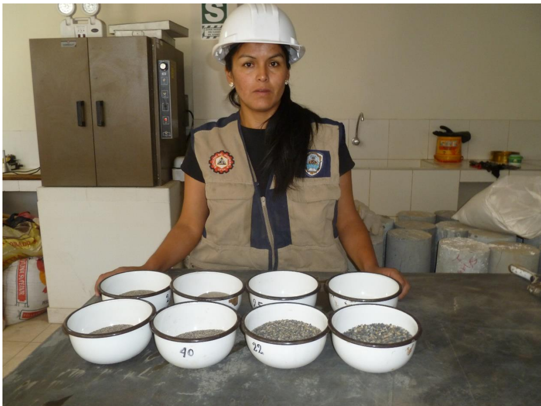
Imagen N° 04. Análisis Granulométrico de Agregados, para el Diseño de Mezcla.
