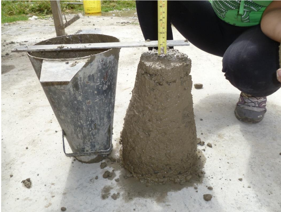
Imagen N° 07. Ensayo de asentamiento SLUMP al 2%
