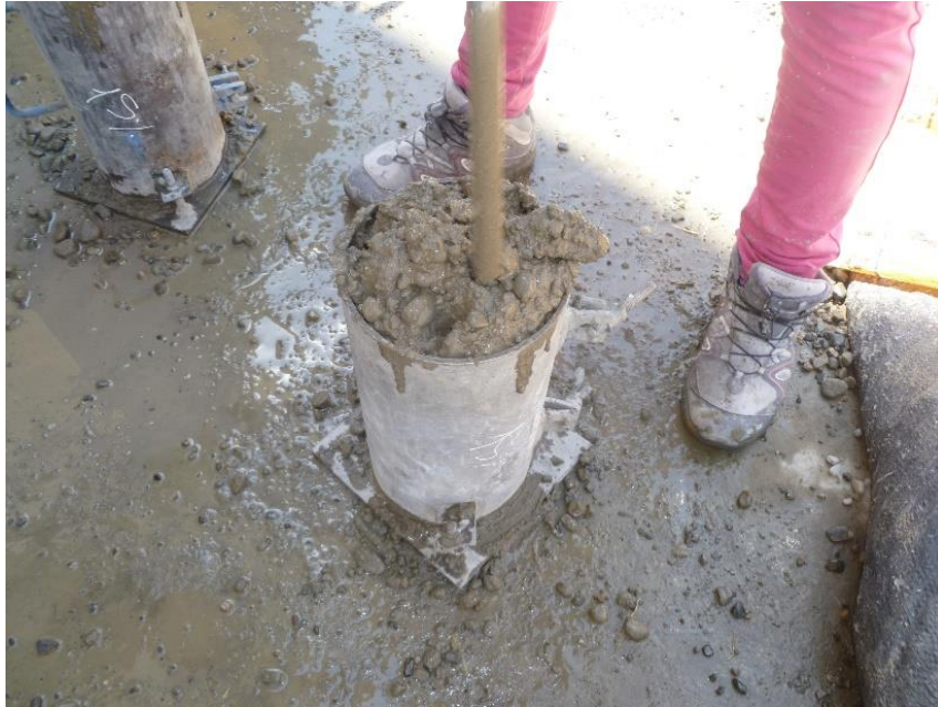
Imagen N° 09. Varillado del concreto.
