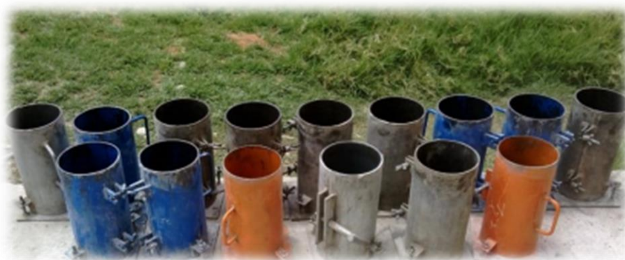
Foto N° 03. Moldes cilíndricos para probetas de concreto
