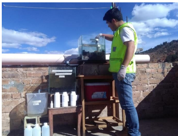
Foto N° 39: Biofiltro prototipo en donde se realizó el experimento del agua.
