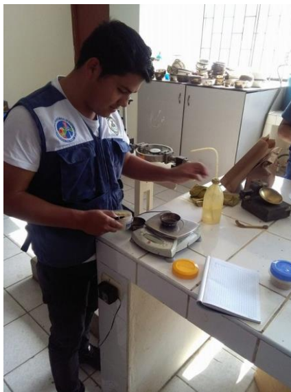
Foto N° 10: Realizando el límite líquido
