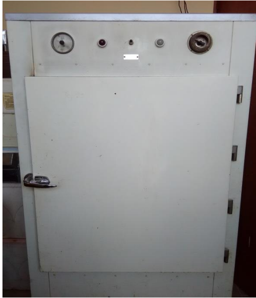
Foto N° 32: temperatura de calcinación (450°C x 45min)
