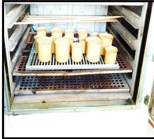
Foto N° 6: colocación de la arcilla al horno
