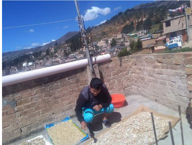
Foto N° 8: Pulverización de la arcilla
