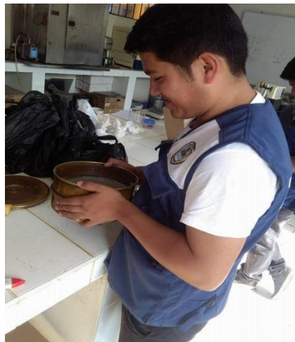
Foto N° 9: Tamizado de la arcilla en la malla N° 200
