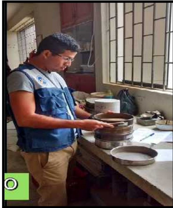
Foto 7. Gradación del agregado Fino.
