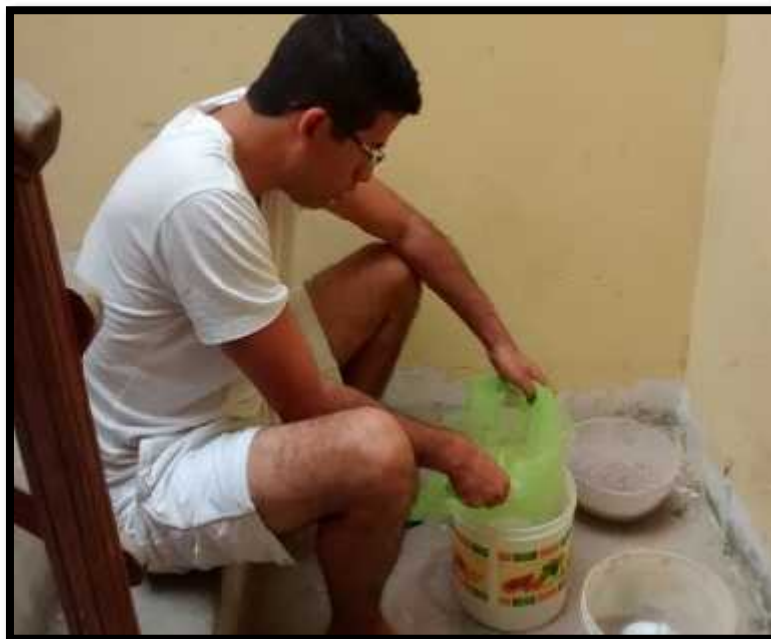
Foto 4. Trituración y tamizado del Material.
