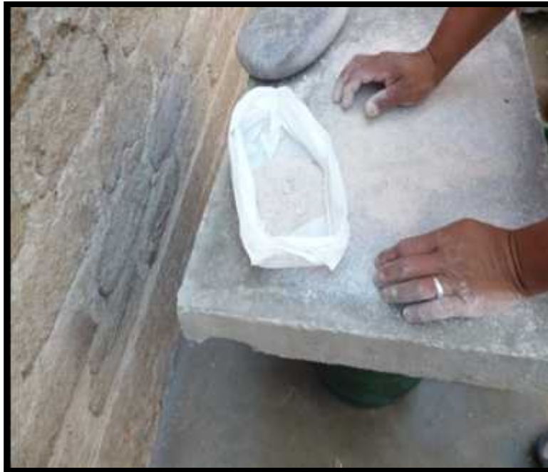
Foto 3. Trituración de la Roca Zeolita.
