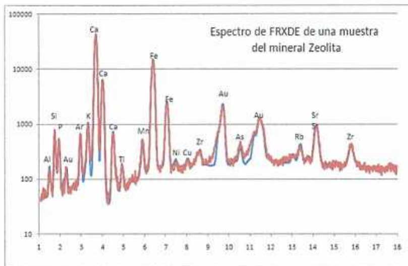
Figura 1. Espectro de FRXDE de una muestra de zeolita en escala semi logarítmica. Incluye el pico de Ar del aire y los picos de rayos-X de Au dispersados por la muestra. La curva en azul muestra el espectro simulado
