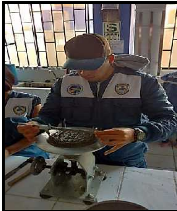
Foto 8. Fluidez de la Mezcla del Mortero Patrón.
