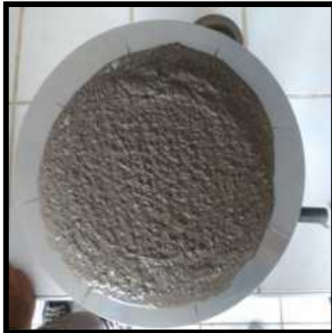
Fotos 11,12. Fluidez de la Mezcla de los Morteros Experimentales al 15% y 20%.
