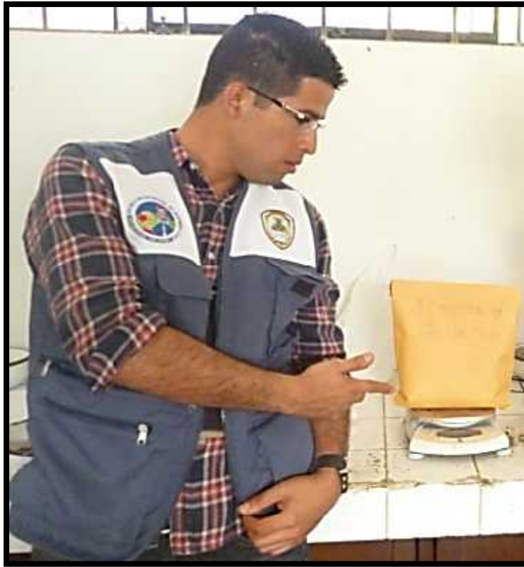
Foto 5. Peso del Material y Tamizado por la Malla N° 200.
