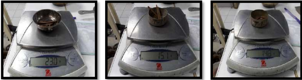
Fotos 35, 36, 37. Muestras listas para secar en el horno a una temperatura de 110°C por 24 horas y hacer los cálculos para hallar el Limite Pastico
