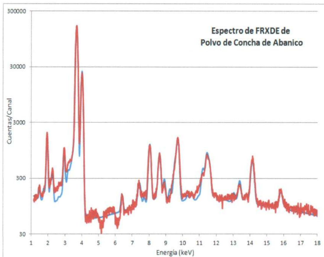
Figura 1. Espectro de FRXDE de polvo de concha de abanico en escala semi logarítmica. Incluye el pico de Ar del aire y los picos de rayos-X de Au dispersados por la muestra. La curva en azul muestra el espectro simulado
