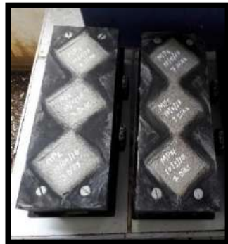
Fotos 115, 116. Desmoldado de Cubos de Mortero Patron.
