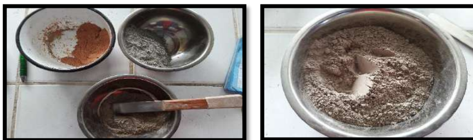
Fotos 104, 105. Cuarteo y combinación del Cemento, Arcilla Calcinada y Polvo de Conchas de Abanico Calcinada.
