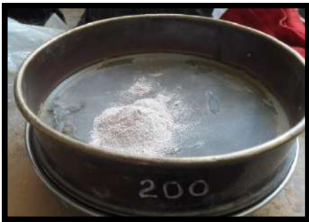
Foto 58. Tamizado del Polvo de las Conchas de Abanico por la malla N°200.
