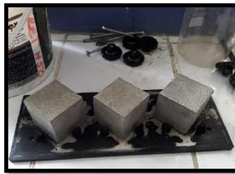
Fotos 115, 116. Desmoldado de Cubos de Mortero Patron.
