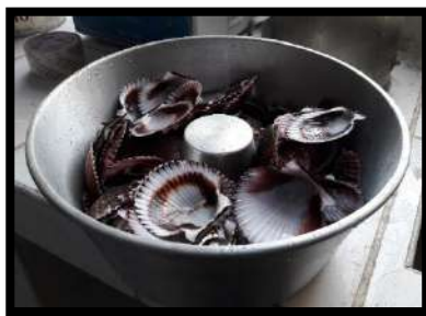
Fotos 52, 53, 54. Secado de las conchas de abanico en el horno de universidad San Pedro a 110°C por 24 horas.
