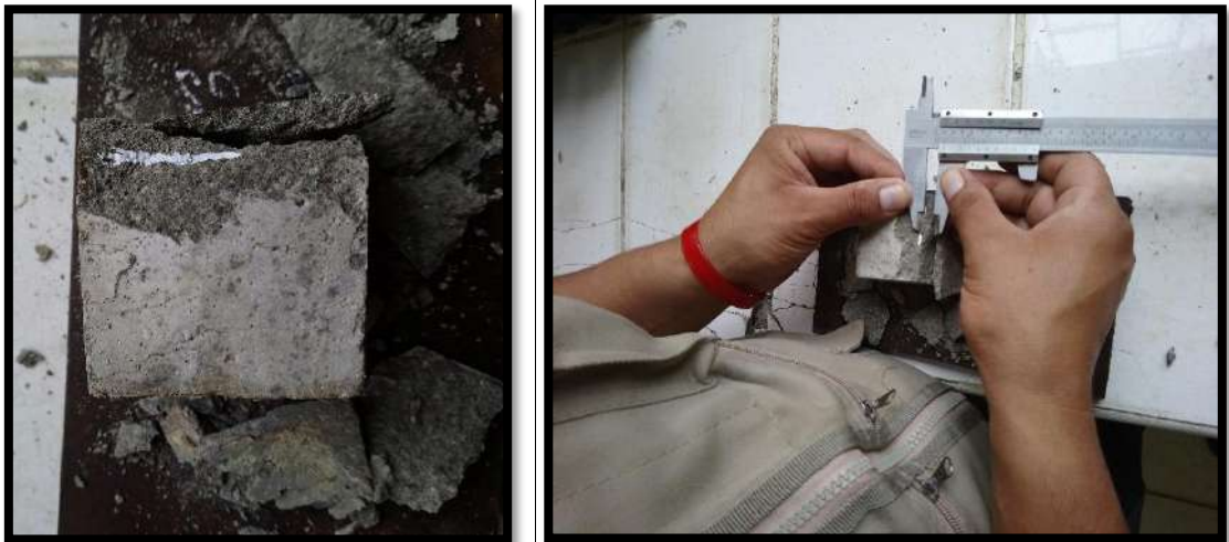
Foto 130, 131. Ensayo de Permeabilidad del Mortero
