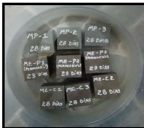
Foto 124, 125. Desmolde y Curado de los Morteros Patrón y Experimentales para 28 días según la norma NTP 334.051
