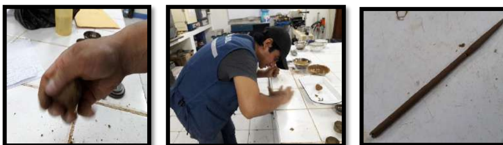
Fotos 32, 33, 34. Proceso de ensayo de Limite Plástico según lo especificado en la MTC E 111
