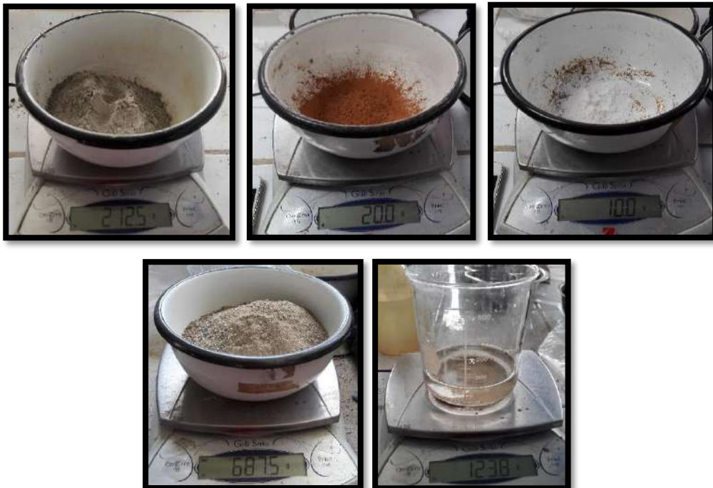
Fotos 118, 119, 120. Pesos Cemento portland, Arcilla Calcinada, Polvo de Conchas de Abanico Calcinada, Arena y Agua para la elaboración de 3 especímenes según la norma NTP 334.051 y una relación A/C de 0.495 según ensayo de fluidez.
