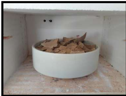
Fotos 38, 39, 40, 41. Calcinación de la Arcilla de Carhuaz a 600°C por 1 hora y 30 minutos según antecedentes.
