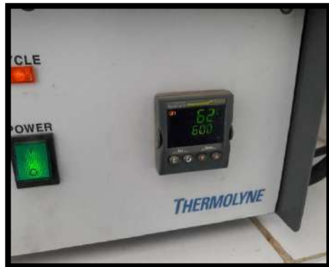
Fotos 38, 39, 40, 41. Calcinación de la Arcilla de Carhuaz a 600°C por 1 hora y 30 minutos según antecedentes.
