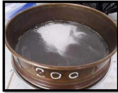
Fotos 69, 70. Trituración y Tamizado del Polvo de Conchas de Abanico Calcinadas por la malla N°200.
