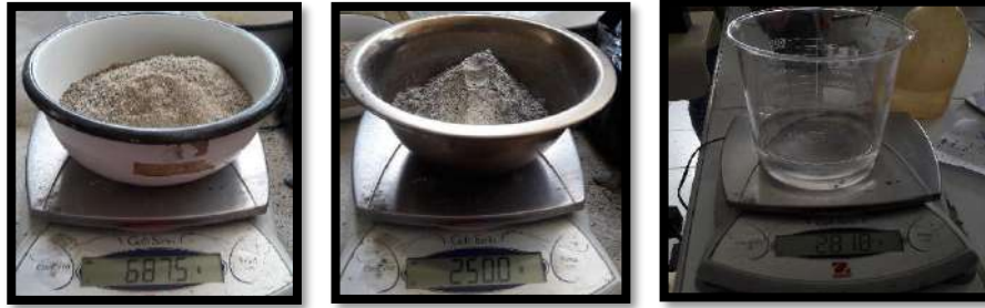
Fotos 88, 89, 90. Peso de Agregado Fino, Cemento Pacasmayo Tipo I y Agua para el ensayo de fluidez según la norma MTC E 616.
