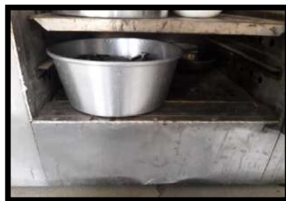
Fotos 52, 53, 54. Secado de las conchas de abanico en el horno de universidad San Pedro a 110°C por 24 horas.
