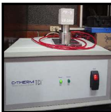
Foto 126, 127. Ensayo de Conductividad Térmica en el analizador C-THEM TCI
