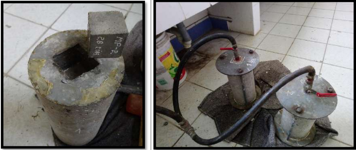
Foto 128, 129. Armado y colocación del mortero en moldes para ensayo de permeabilidad
