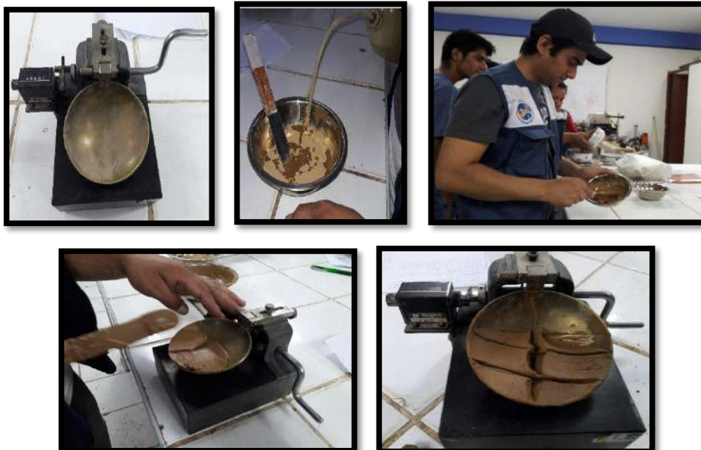
Foto 24, 25, 26, 27, 28. Ensayo Limite Liquido en copa Casa Grande tal como lo indicado en la normal MTC E 110.
