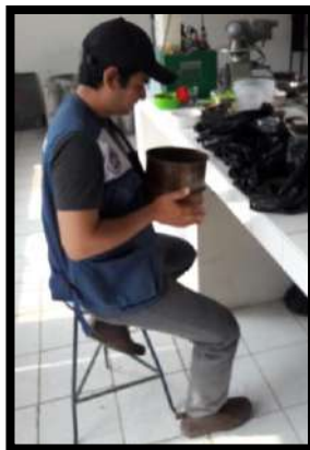
Fotos 79, 80, 81, 82, 83, 84, 85. Gradacion del Agregado Fino utilizando las mallas N°4, N°8, N°16, N°30, N°50, N°100, N°200, según la N.T.P. 400.037.
