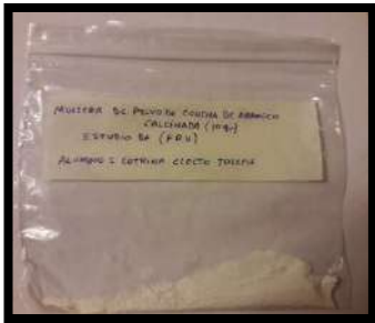
Fotos 69, 70. Trituración y Tamizado del Polvo de Conchas de Abanico Calcinadas por la malla N°200.
