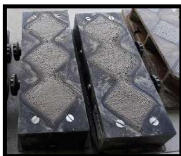
Foto 123. Elaboración del mortero según lo especificado en la NTP 334.051
