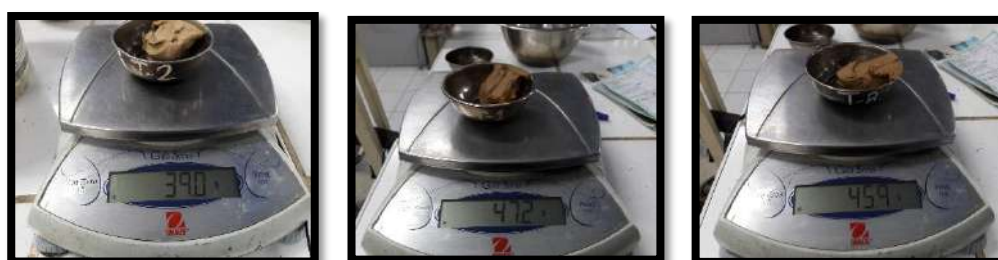
Fotos 29, 30, 31. Muestras listas para secar en el horno a una temperatura de 110°C durante 24 horas para determinar el Limite Liquido
