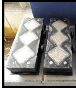
Fotos 111, 112, 113, 114, 115, 116, 117, 118. Proceso de elaboración del Mortero Patron para 28 días de curado según la NTP 334.051.
