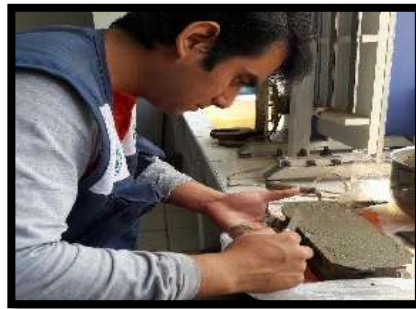
Fotos 111, 112, 113, 114, 115, 116, 117, 118. Proceso de elaboración del Mortero Patron para 28 días de curado según la NTP 334.051.
