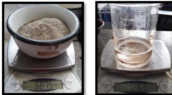
Fotos 98, 99, 100, 101, 102, 103. Pesos de Cemento, Arcilla Calcinada, Polvo de Conchas de Abanico Calcinada, Agregado fino gradado y Agua para la fluidez.
