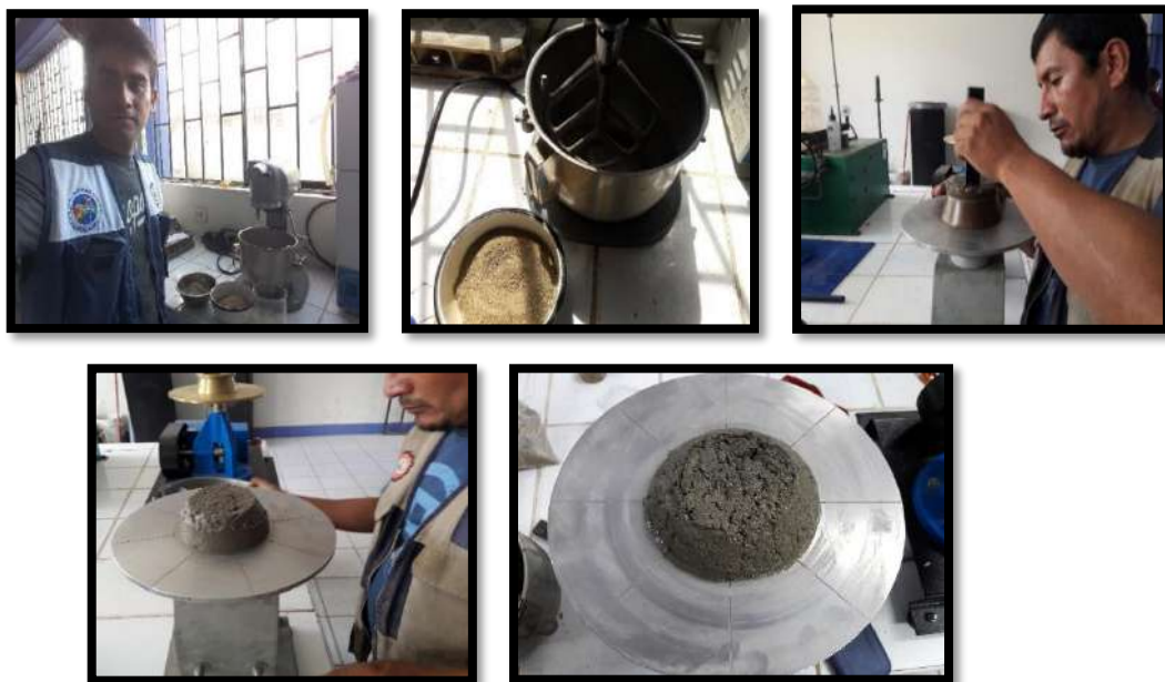
Fotos 88, 89, 90. Peso de Agregado Fino, Cemento Pacasmayo Tipo I y Agua para el ensayo de fluidez según la norma MTC E 616.
