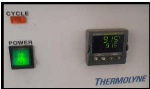
Fotos 60, 61, 62, 63, 64, 65, 66. Calcinación de Conchas de Abanico a 915°C por 1 hora y 30 minutos en la mufla del Laboratorio de la USP.
