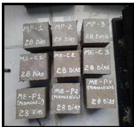
Foto 124, 125. Desmolde y Curado de los Morteros Patrón y Experimentales para 28 días según la norma NTP 334.051
