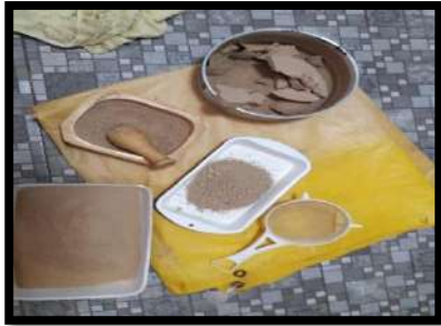
Foto 17, 18, 19. Trituración de arcilla secada
