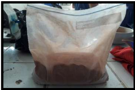
Fotos 42, 43, 44. Arcilla Calcinada y guardada en bolsa hermética para evitar contaminación.
