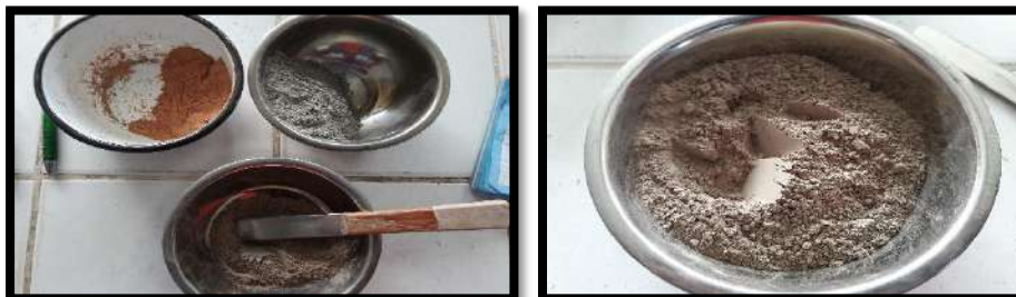
Fotos 121, 122. Cuarteo del Cemento portland, Arcilla calcinada y Polvo de conchas de Abanico para una mezcla homogénea
