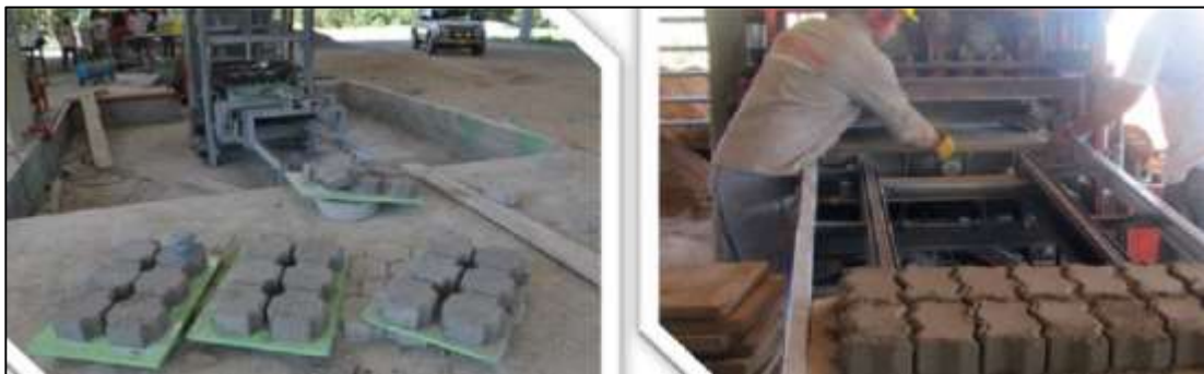
Figura N° 1: Fabricación mecanizada de grandes lotes de adoquines
