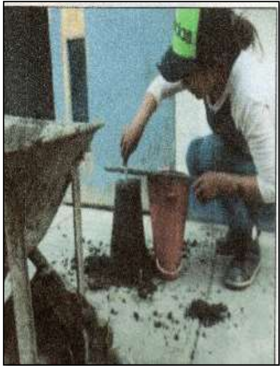
Foto N° 31: Ensayo de Consistencia del Concreto
