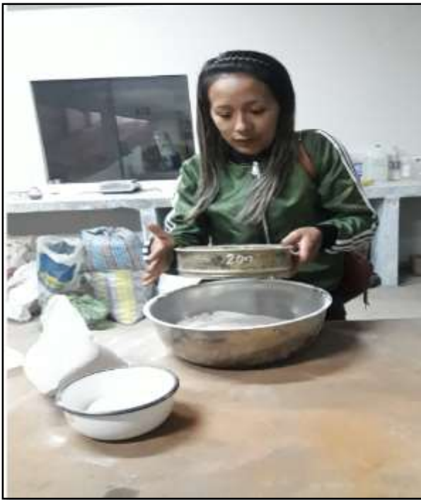
Foto N° 16: Se observa el tamizado de la cascara de huevo y bagazo de cebada
