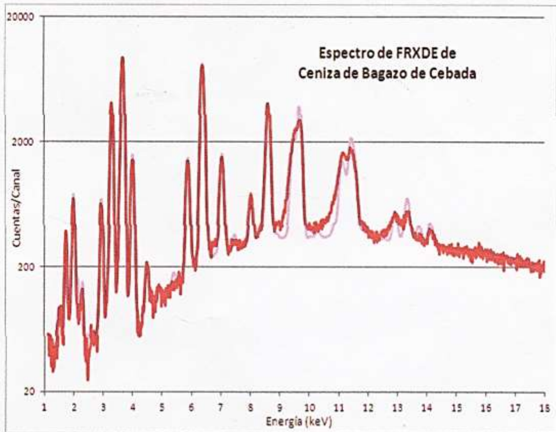
Figura 1. Espectro de FRXDE de ceniza de bagazo de cebada en escala semi-logarítmica. Incluye el pico de Ar del aire y los picos de rayos-X de Au dispersados por la muestra. La curva en azul muestra el espectro simulado
