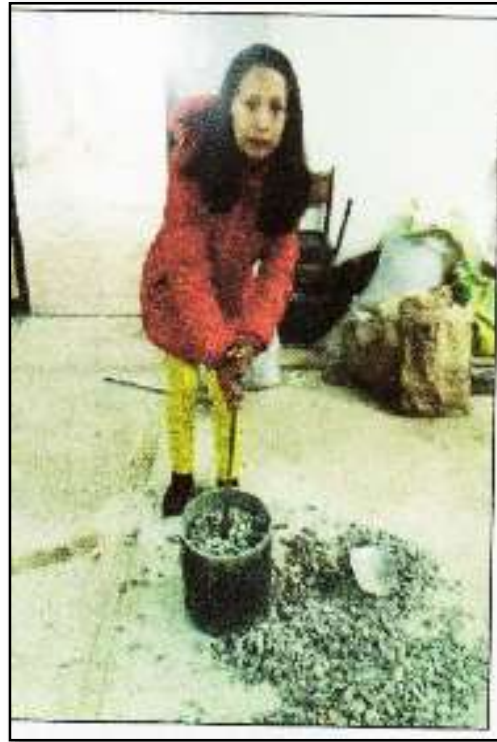
Foto N° 12: Varillado del Agregado Grueso
