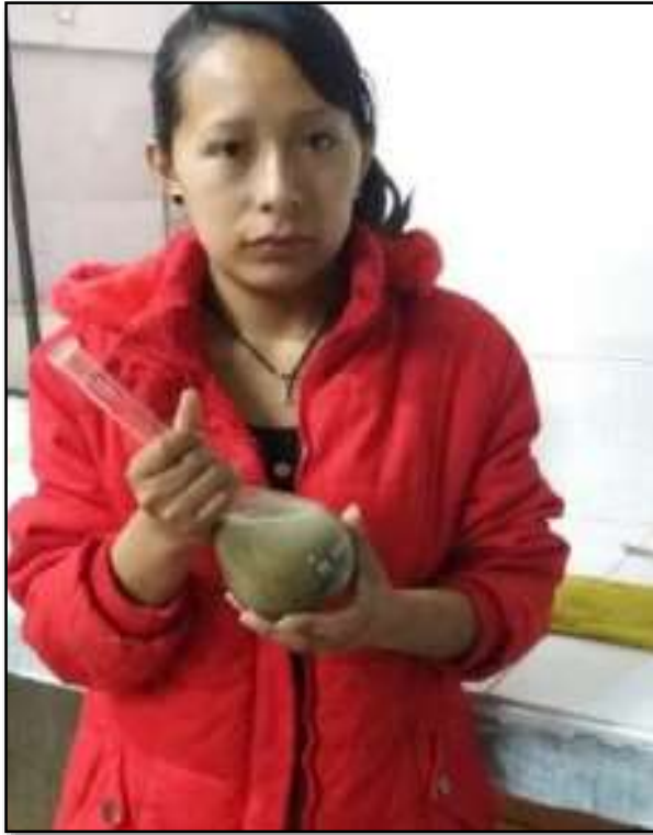
Foto N° 15: Se observa la Elaboración del Peso Específico de los agregados
