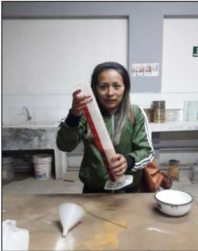
Foto N° 17: Se observa la realización de peso específico de los materiales
