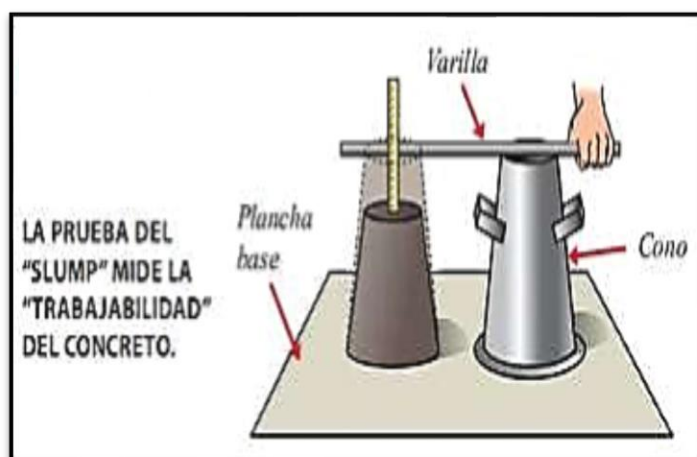
Figura 1. Prueba de Slump
