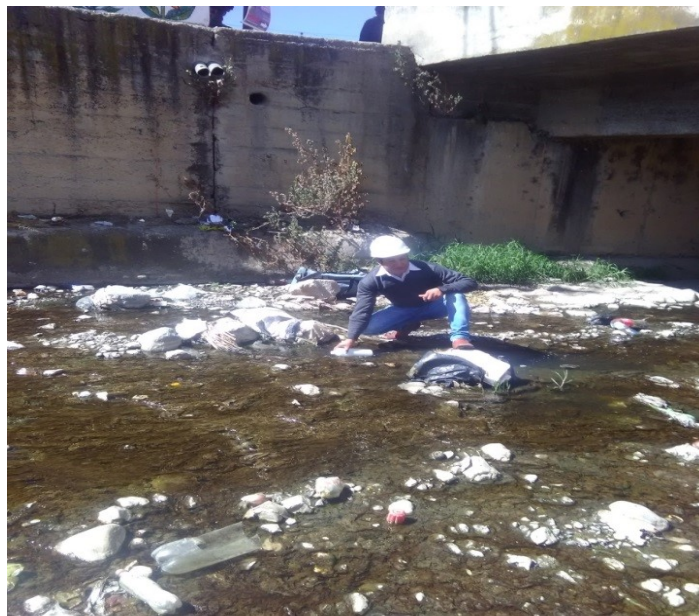
Foto N° 39 extracción de la cuarta muestra (M4), coordenadas E: 61486, N: 5212464
