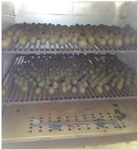
Foto N° 32: colocación de esferas al horno (gr)
