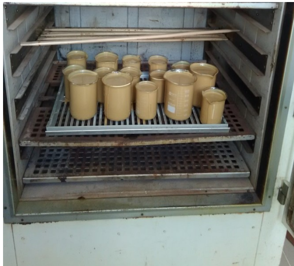
Foto N° 7: colocación de la arcilla al horno
