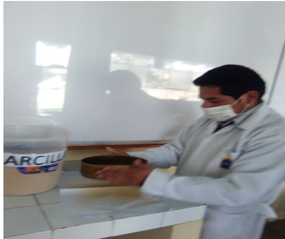
Foto N° 10: tamizado de la arcilla en la malla N° 200
