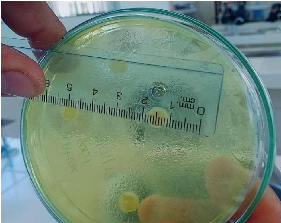
Foto N° 20: Placa con látex al 100 % con formación de halo de 2.8 cm
