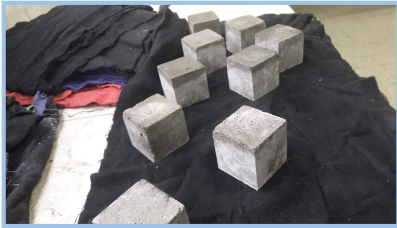
FIGURA N°26: DESENCOFRADO DE MORTEROS PATRONES
