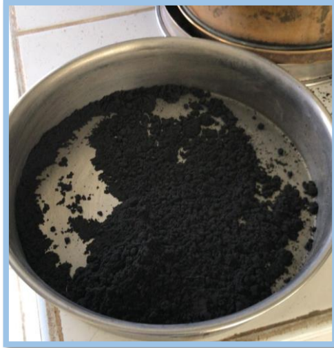
FIGURA N°16: MUESTRA DE RASTROJO DE MAIZ PUESTA A CALCINAR (PAG. 37)
