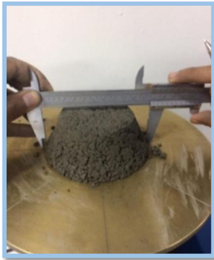
FIGURA N°22: FLUIDEZ DE MORTERO EXPERIMENTAL (PAG. N°42)
