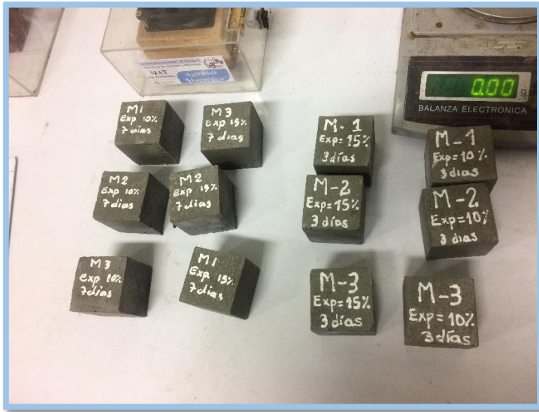
FIGURA N°29: DESENCOFRADO DE MORTEROS EXPERIMENTALES
