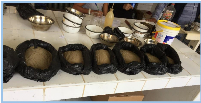
FIGURA N°17: PESADO DE AGREGADO FINO
