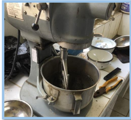
FIGURA N°19 – N°20: ELABORACIÓN DE LA MEZCLA PATRÓN (PAG. N°42)
