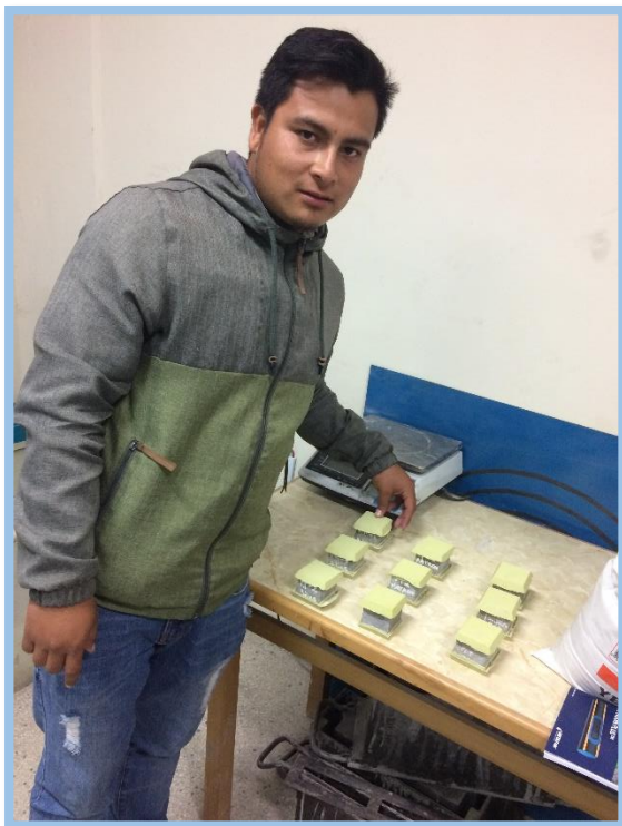
FIGURA N°27 – N°28: MORTEROS PATRONES CAPIADOS Y ENSAYADOS (PAG. N°44)
