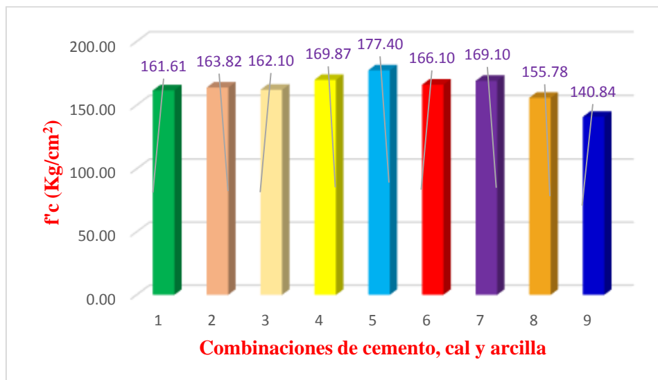
Grafico 10: Resistencia a la compresión adquirida por las 9 combinaciones experimentales a los 7 días de curado
