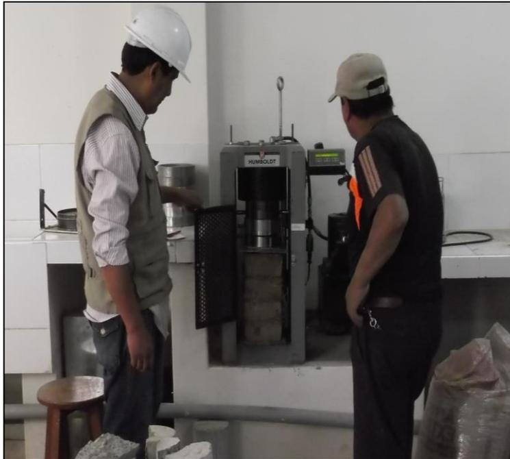
**Imagen 19:** En la imagen se observa el ensayo de las pilas de Adobes.
