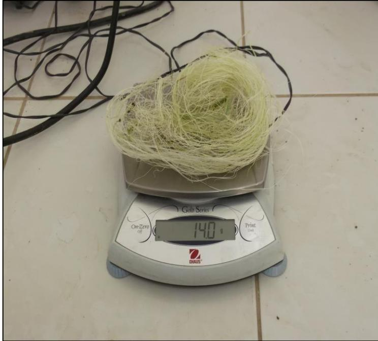
**Imagen 13:** En la imagen se observa el peso Inicial de la fibra de Maguey Para las muestras iniciales.
