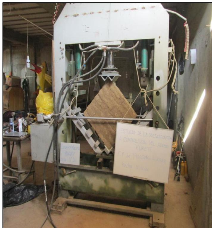
**Imagen 20:** En la imagen se observa la posición Inicial del Murete para su respectivo Ensayo.
