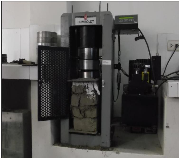
**Imagen 21:** En la imagen se observa la Falla Característica de las Pilas con adobes sin ningún Refuerzo.
