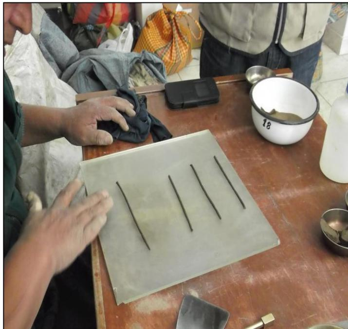
**Imagen 12:** En la imagen se observa el ensayo de límite Plástico
