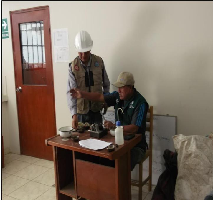
**Imagen 11:** En la imagen se observa el ensayo de límite Líquido mediante la copa de Casagrande.
