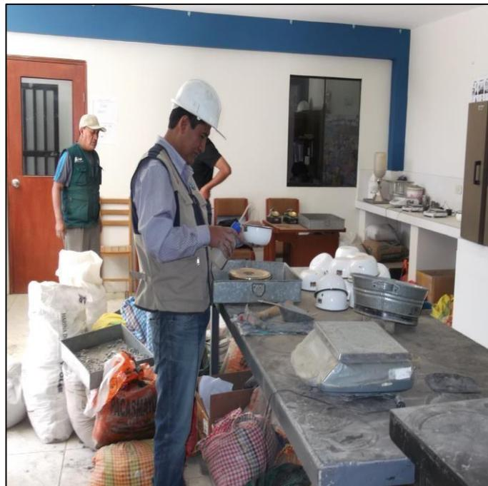
**Imagen 10:** En la imagen observamos la adición de agua a la muestra para determinar la plasticidad.
