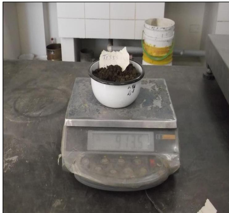
**Imagen 04:** En la imagen podemos ver la toma de Peso de la muestra para su posterior ensayo.
