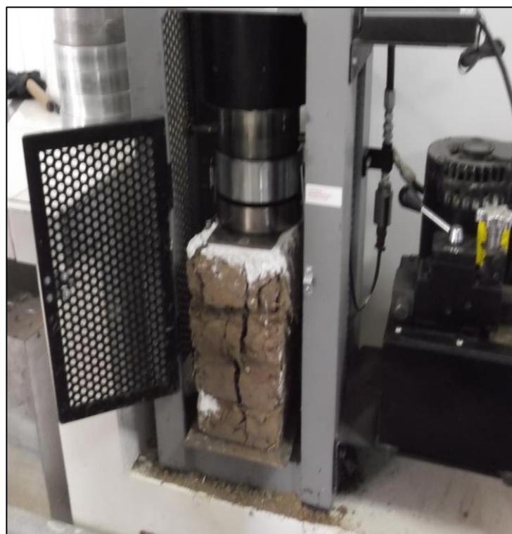
**Imagen 22:** En la imagen se observa la Falla Característica de las Pilas con adobes con Refuerzo de Fibra de Maguey.
