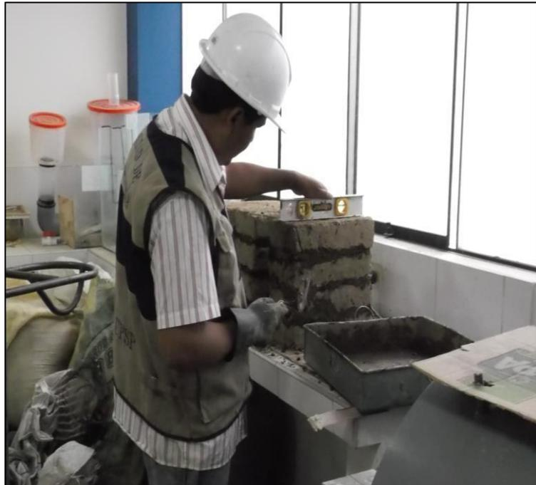
**Imagen 16:** En la imagen se observa la Preparación de las pilas de adobes para su posterior ensayo.
