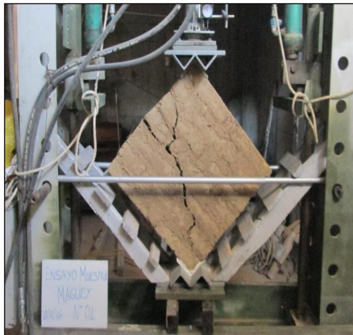
**Imagen 24:** En la imagen se observa la Falla Característica de los Muretes con adobes con Refuerzo de Fibra de Maguay.
