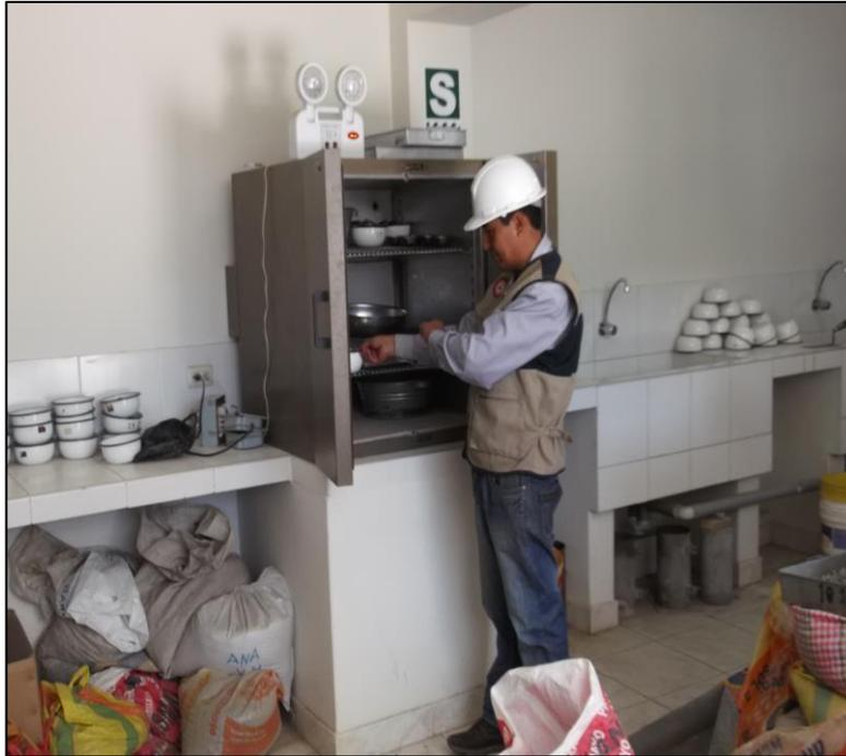
**Imagen 07:** En la imagen se observa el acondicionamiento de la muestra en el Horno para su posterior determinación de Contenido de Humedad.
