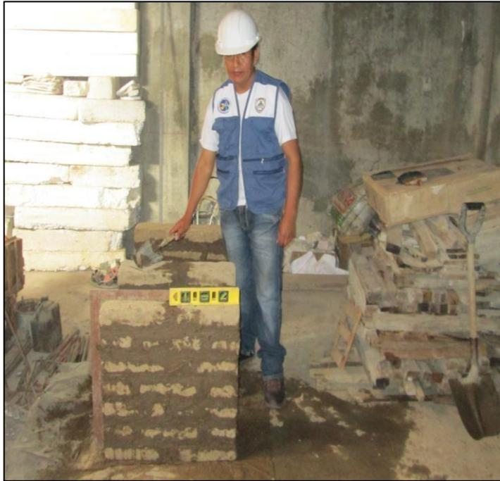
**Imagen 17:** En la imagen se observa la Preparación de los muretes de Adobes.
