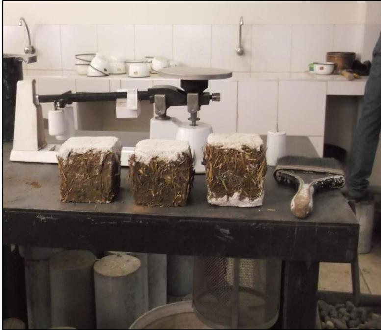
**Imagen 15:** En la imagen se aprecia los cubos listos para su ensayo debidamente prismáticos.
