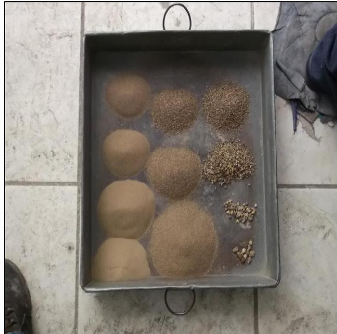
**Imagen 08:** En la imagen podemos observar la composición granulométrica de la Muestra.
