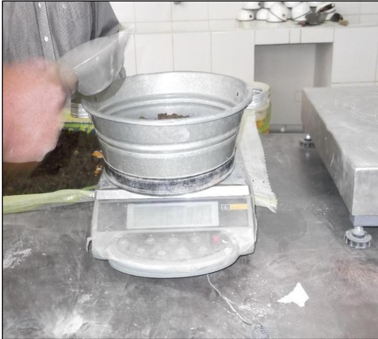
**Imagen 03:** En la imagen podemos ver la toma de peso para la fabricación de las muestras de Adobe.
