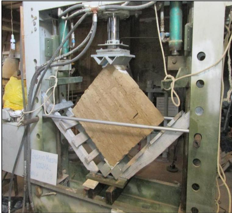
**Imagen 23:** En la imagen se observa la Falla Característica de los Muretes de adobe sin Refuerzo.
