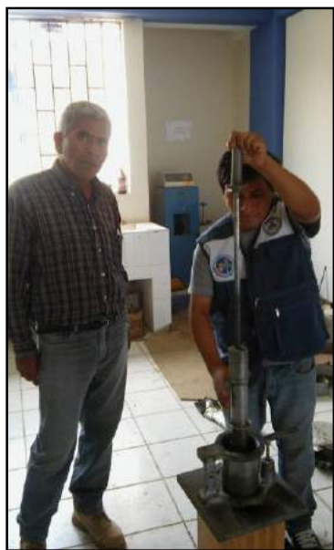
Foto 15. compactando 75 golpes y obteniendo las briquetas. Fuente: El autor
