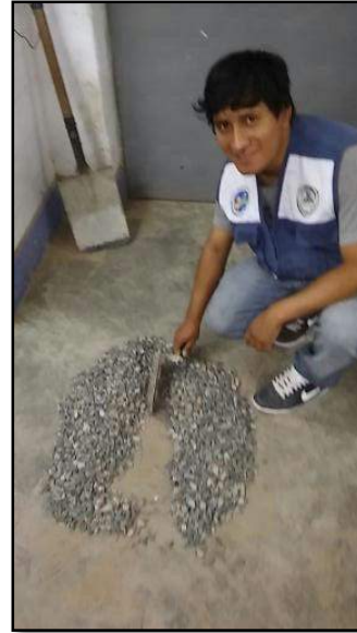
Foto 07. Cuarteo del material. Fuente: El autor
