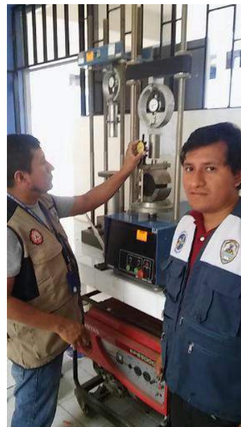
Foto 22: Ensayo Marshall viendo el flujo de la briqueta. Fuente: El autor
