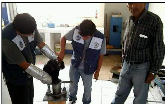
Foto 14. Llenado la mezcla en los moldes. Fuente: El autor.
