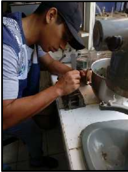
Foto N° 11: Realizando los cubos de mortero
