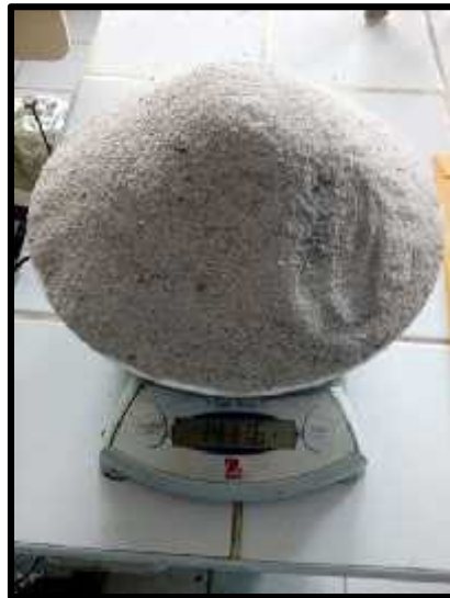
Foto N° 08: Ceniza de cáscara de arroz calcinada a 360°C
