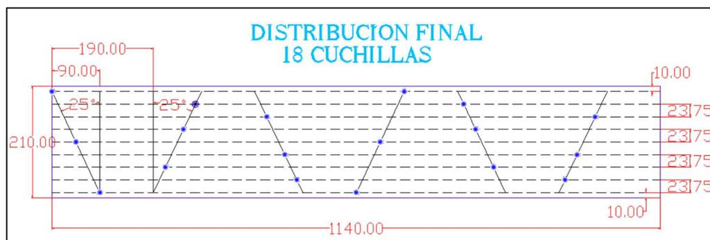
Figura 9. Desarrollo Del Rotor Triturador Y Distribución De 18 Cuchillas.
