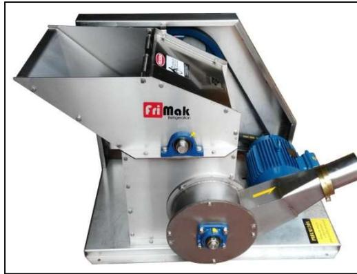
Figura 3. Máquina Trituradora de Hielo con Impulsor (Fri Mak Refrigeration, 2002)
