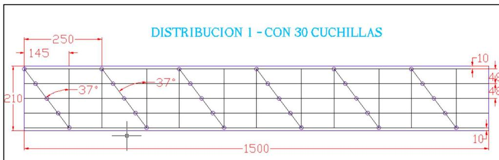
Figura 8. Desarrollo del Rotor Tritrador y Distribución de la forma de 30 Cuchillas
