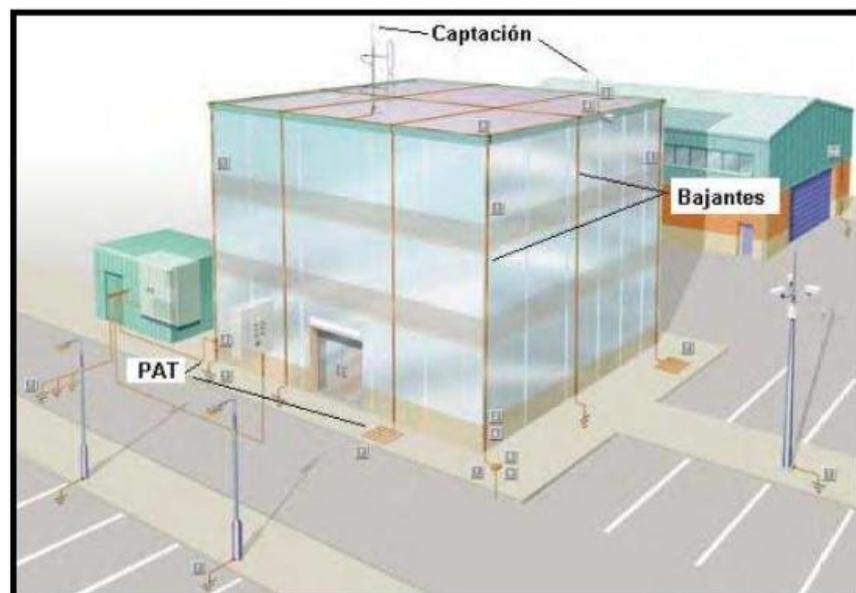
Figura N° 03. Protección contra descargas atmosféricas
