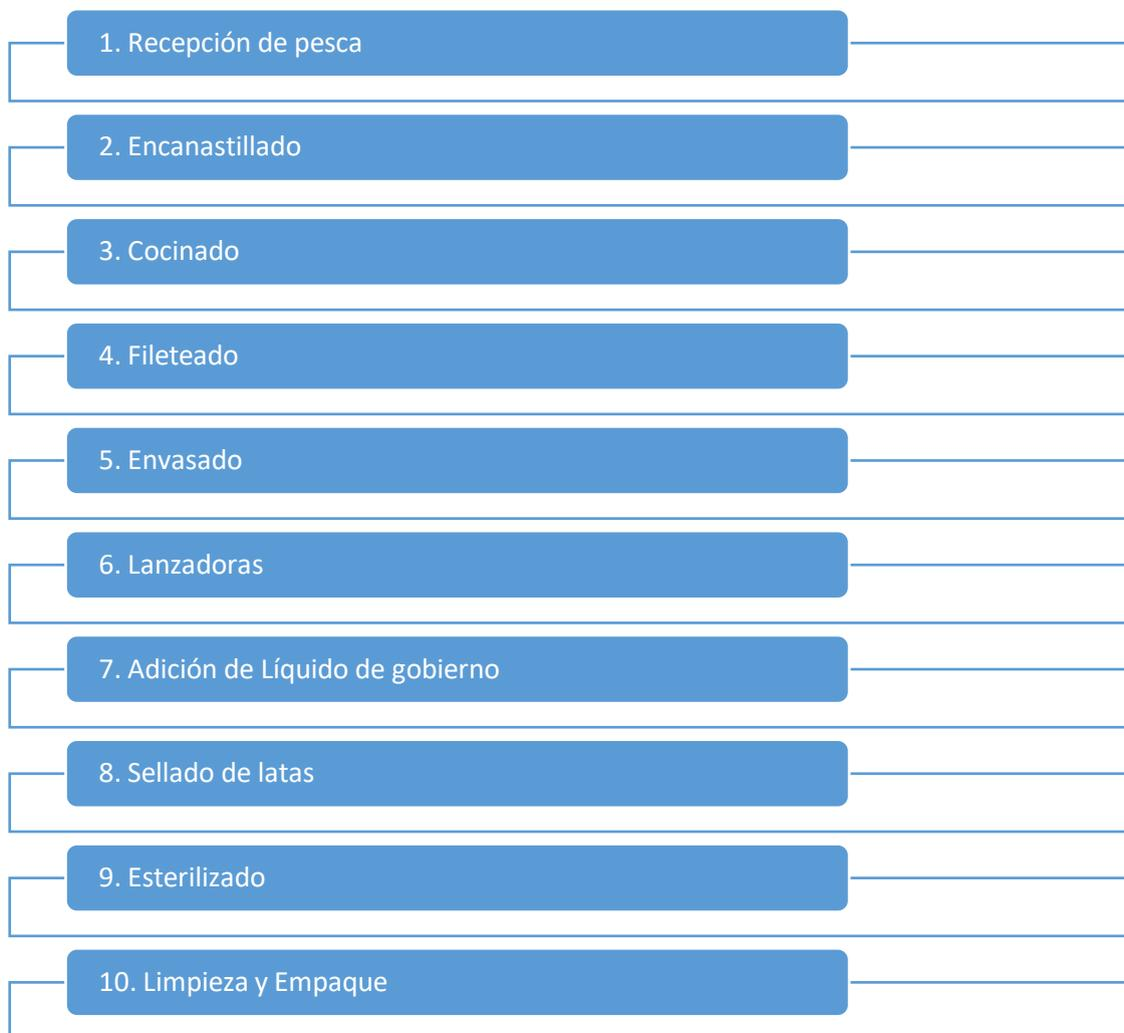
Figura 1: Actividades del proceso de la línea de cocido de la planta de conservas.
