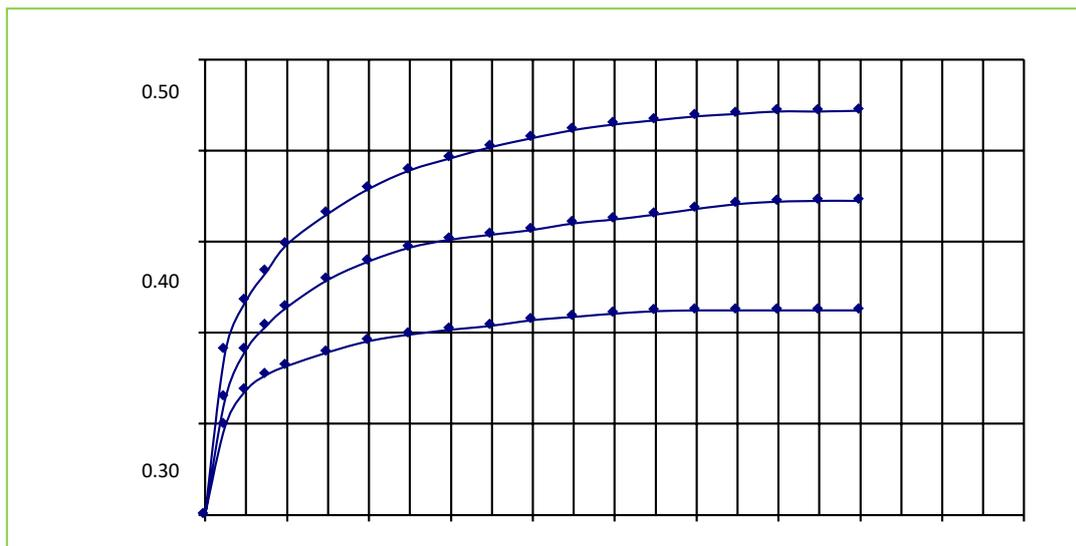
**Figura 36:** Esfuerzo de corte y deformación tangencial del suelo de C alicata 2
