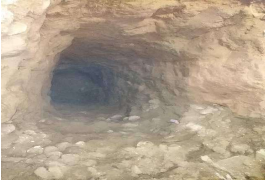
Figura 127: Se observa la calicata N° 02 excavada, en la cual se aprecia la estratigrafía del suelo
