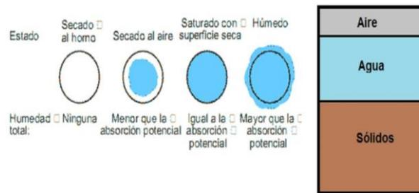
**Figura N°3:** Procedimiento del contenido de humedad
