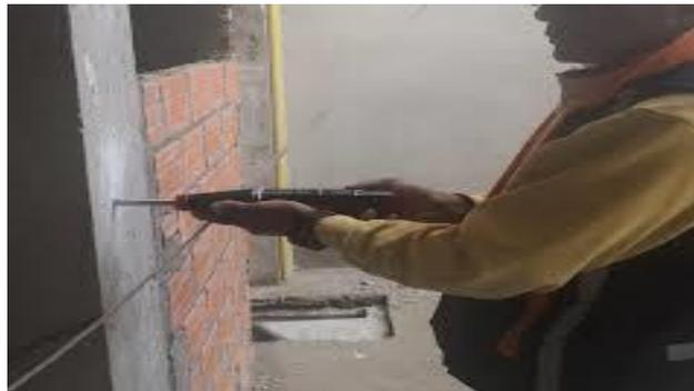
**Figura N°7:** *Ensayo de esclerometría*
