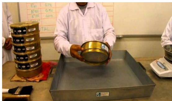
**Figura N°4:** Procedimiento del análisis granulométrico
