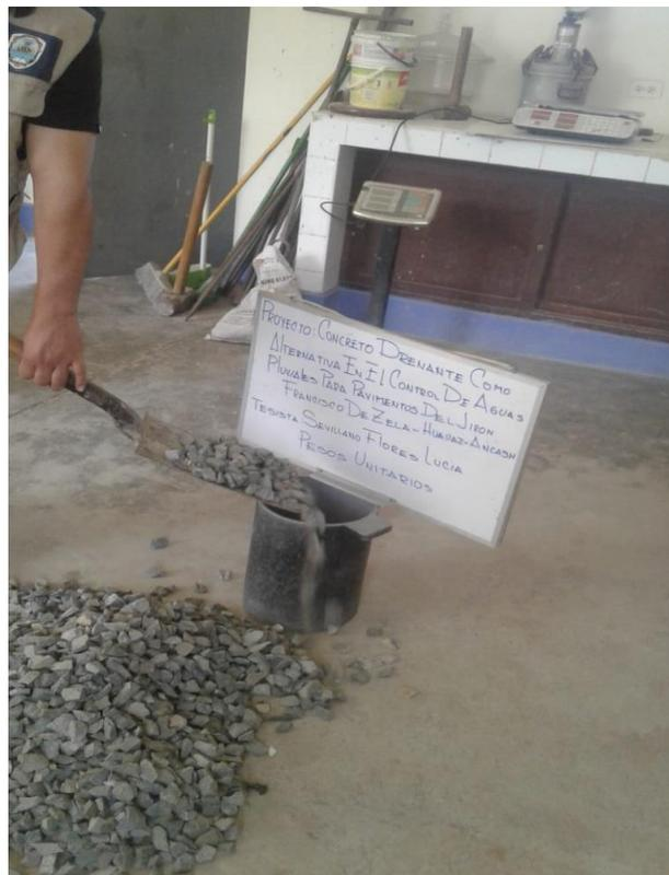
**Imagen 02: Proceso para la realización de las pruebas de peso unitario.**
