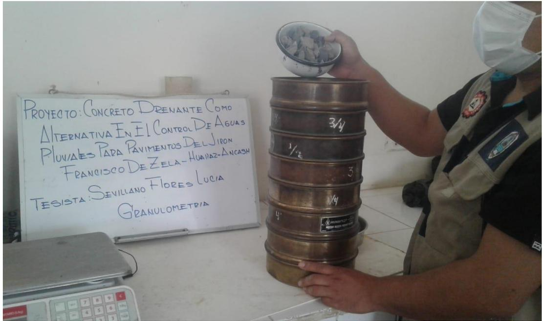
**Imagen 03: Ensayos de granulometría en el laboratorio.**
