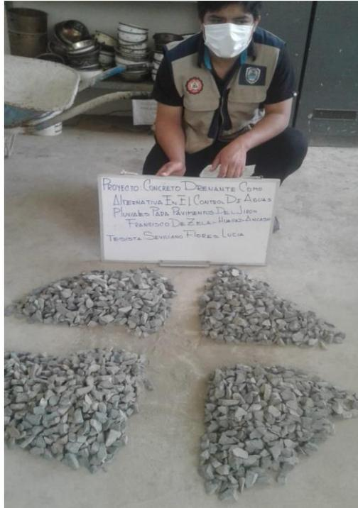
**Imagen 01: Cuarteo de los agregados, para la toma de muestra.**
