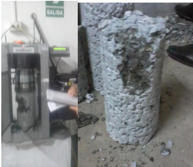
**Imagen 04: Rotura de briquetas en el laboratorio.**
