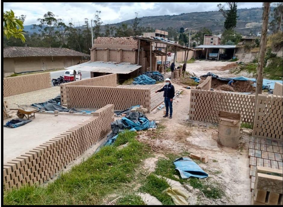
*Figura 26* Secado y arrumado de ladrillo FB A-01.
