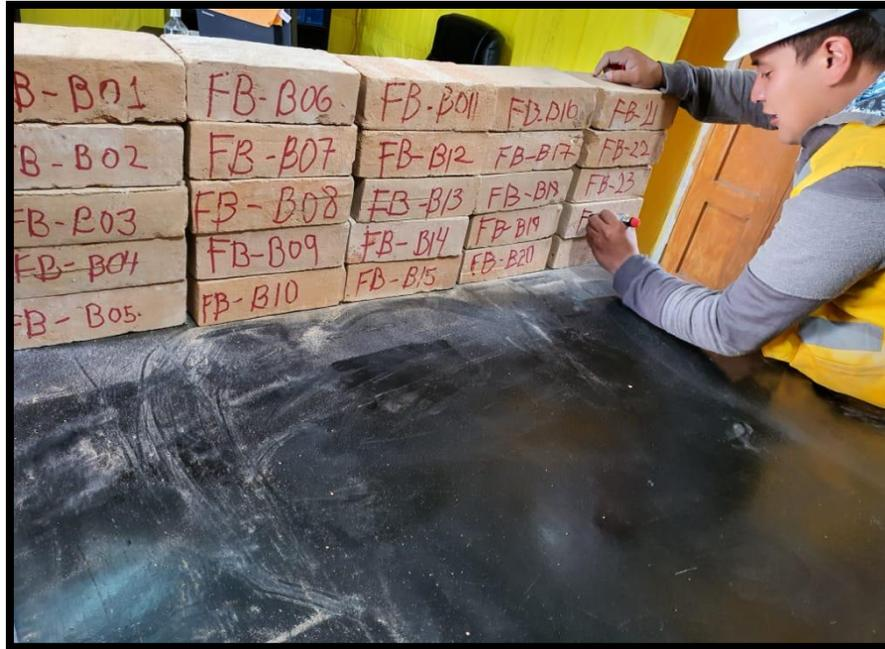
Figura 40 Ensayo de variación dimensional
