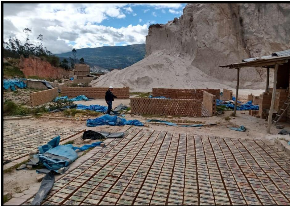
*Figura 29* Secado y arrumado de ladrillo FB A-02.
