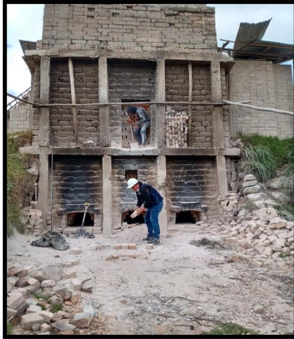
*Figura 32* Extracción de unidades del horno FB A-01.
