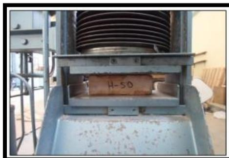
Figura 8 Ensayo de Resistencia a la Compresión del ladrillo
