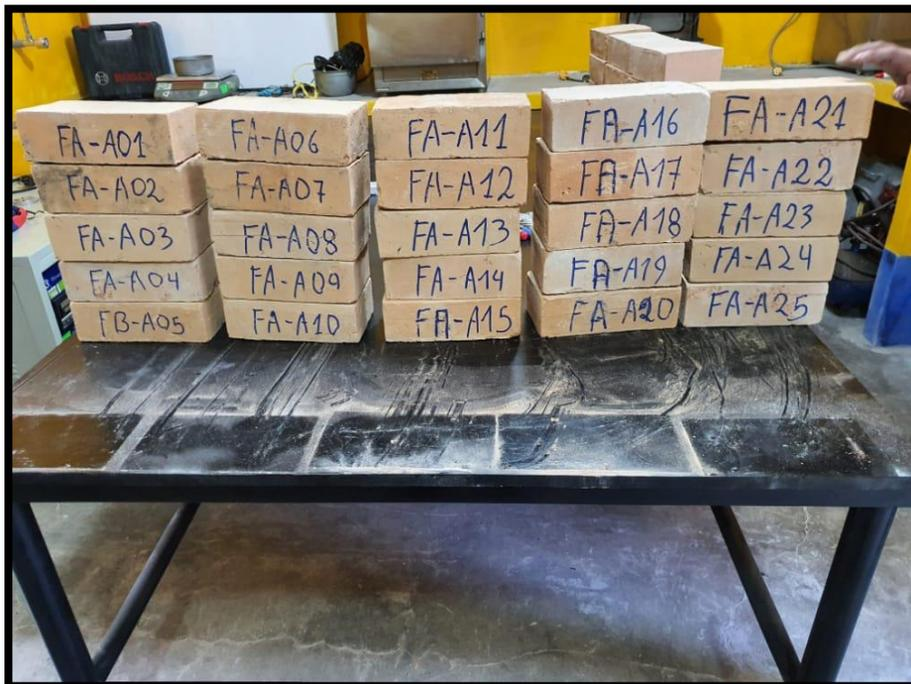
Figura 41 Ensayo de variación dimensional
