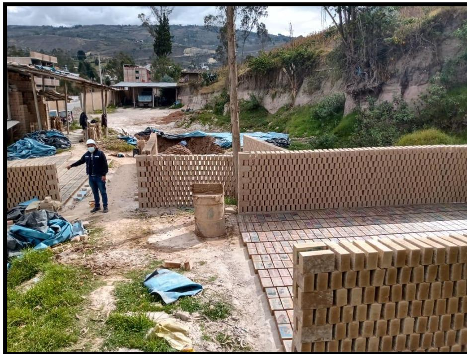
*Figura 27* Secado y arrumado de ladrillo FB A-01.
