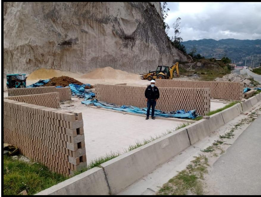
*Figura 30* Secado y arrumado de ladrillo FB A-03.
