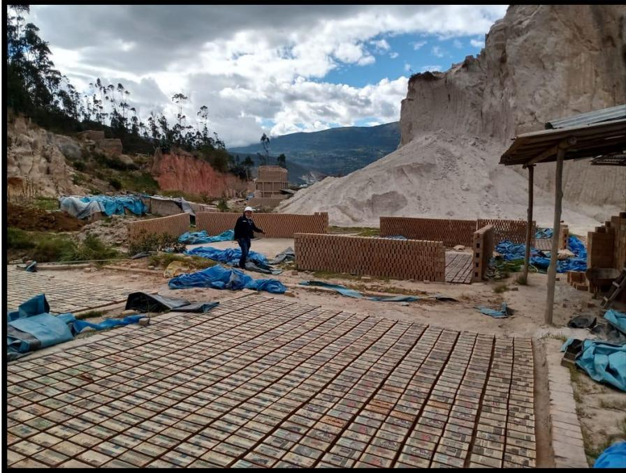
*Figura 28* Secado y arrumado de ladrillo FB A-02.
