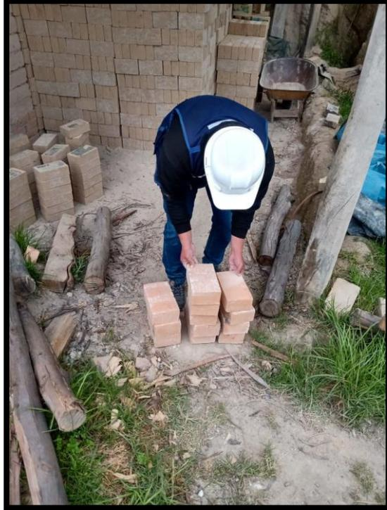
*Figura 34* Extracción de unidades del horno FB A-02.
