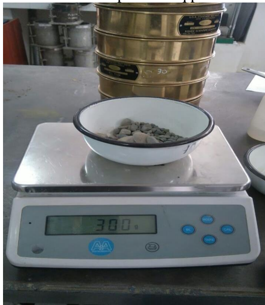
Foto3: Pesando la piedra lo q paso la malla
