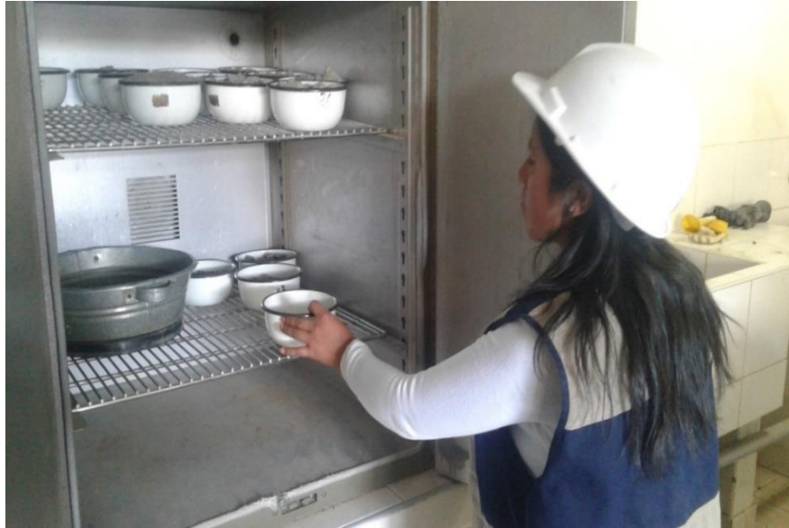
Figura 11: Sacando la muestra de agregados del horno . Laboratorio de Mecánica de Suelos y Ensayo de Materiales de la Universidad San Pedro - Huaraz
