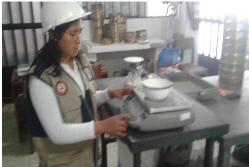
Figura 12: Pesando la muestra para hacer el límites de consistencia de Atterberg, USP
