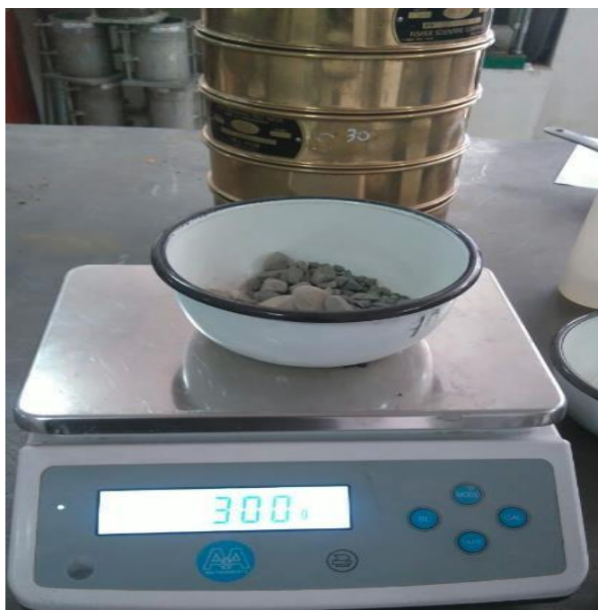
Figura 14. Balanza y tamices utilizados en análisis granulométrico
