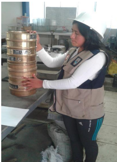
Figura 13. Uso de tamiz en análisis granulométrico
