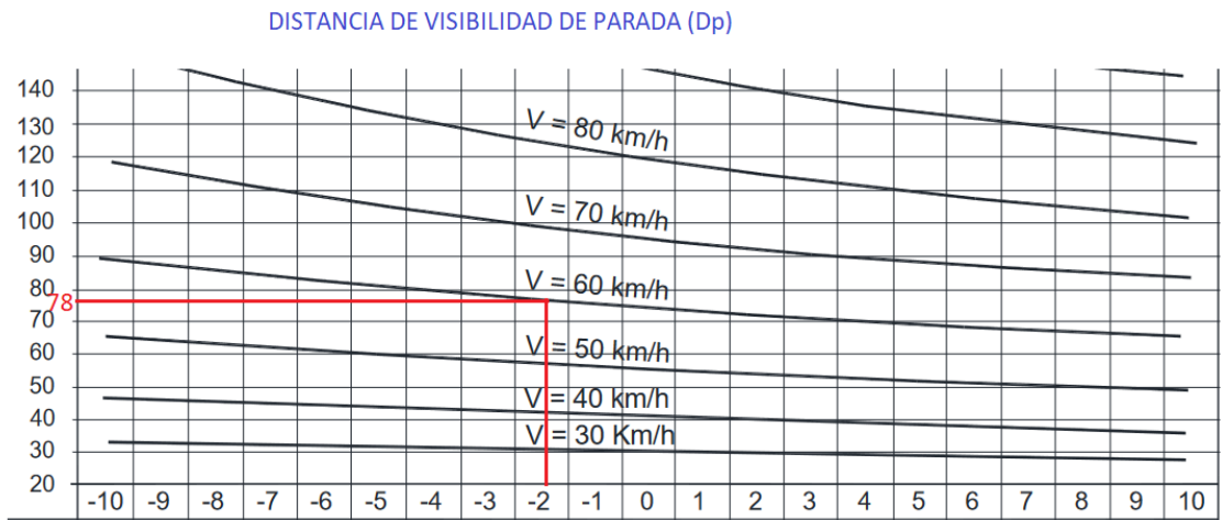
Fig. N° 4: Distancia de visibilidad de parada (pendiente de salida).
